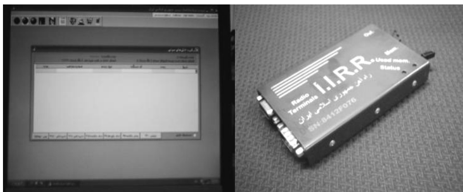
شکل ۲۲-۷ جعبه سیاه ضبط مکالمات و نرم افزار بازخوانی مکالمات
