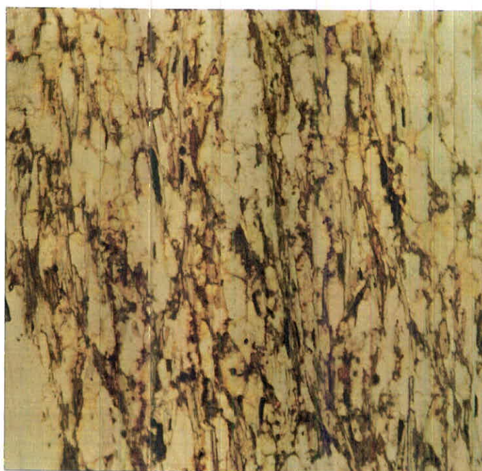
عکس شماره ۶۷ : مقطع نازک میکا شیست (نورعادی) بزرگنمایی ۴۰ برابر
