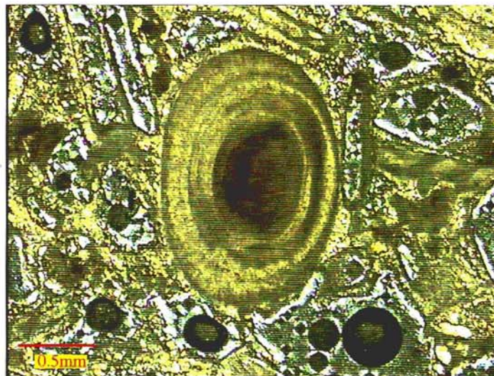
شکل ۲- تصویری از اووئیدهای موجود در نمونه با لایه بندی متحدالمرکز (تصویر در نور XPL).
