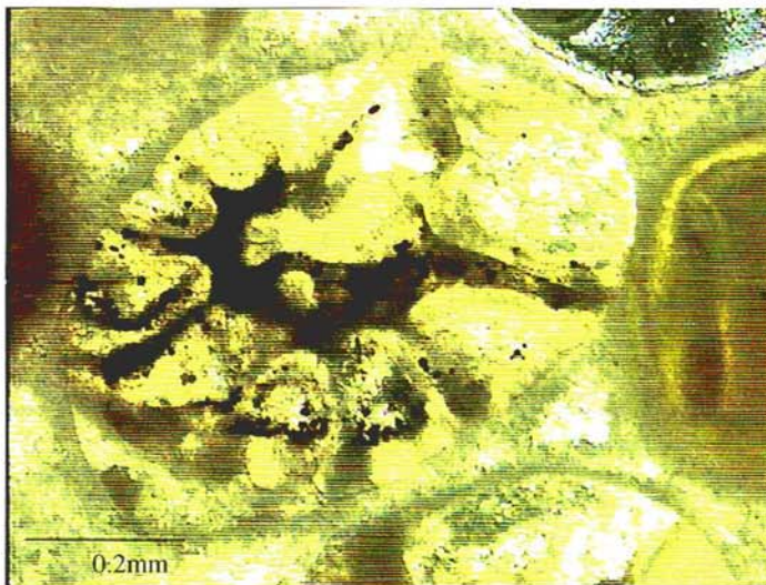
شکل ۴ - تصویری از جانشینی اکسیدهای فلزی در برخی از میکروفسیلها (تصویر در نور XPL).
