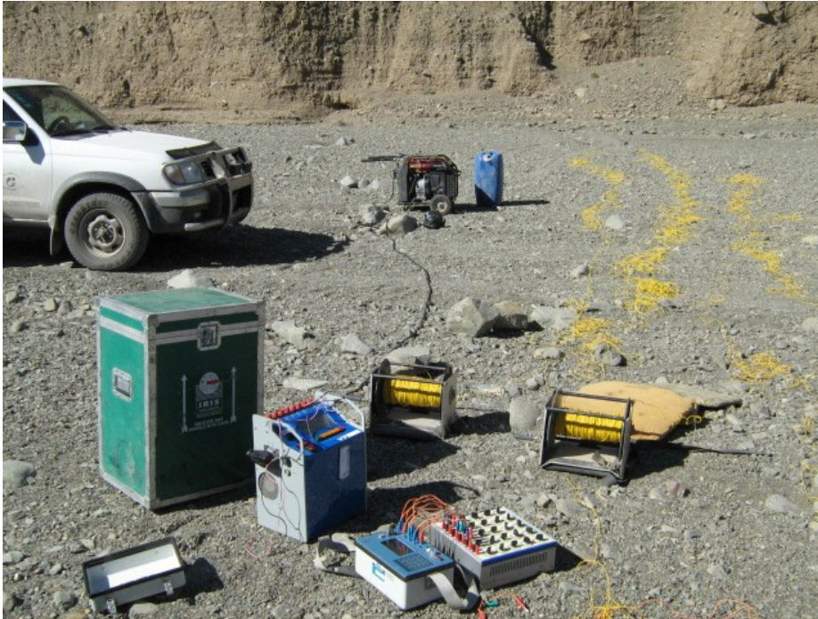
تصویر شماره ۶- مجموعه موتور ژنراتور، ترانسمیتر و رسیور به همراه سیمهای فرستنده جریان
