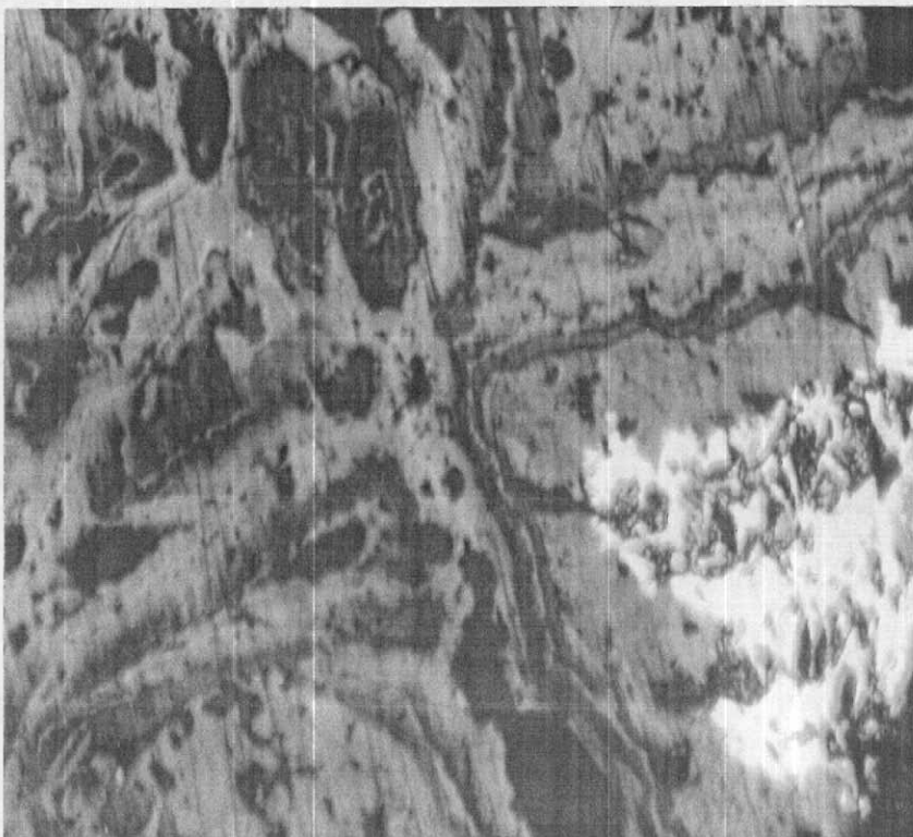
تصویر شماره ۳۳ - نمایی از قشرهای ظریف و کلوئیدی هیدروکسیدهای آهن در اطراف کالکوپیریت باقیمانده در نمونه شماره 2-Tq-Tq - بزرگنمایی PPL (X20×12.5)
