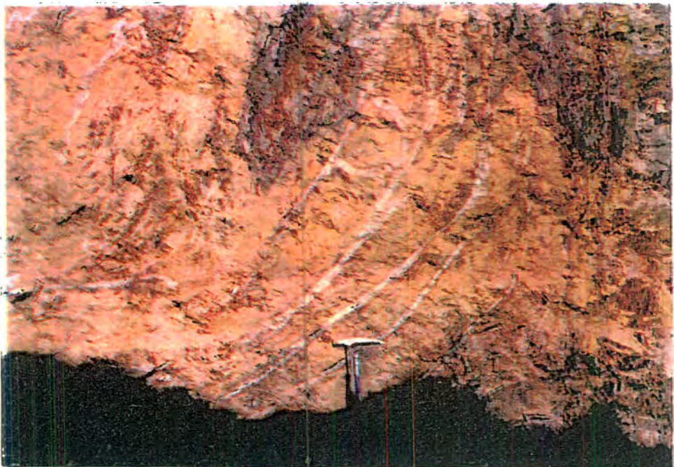
تصویر ۴-۲- رگه ورگچه های نازک سیلیسی در فضاهای خالی و شکستگیهای سریانتینتها .
