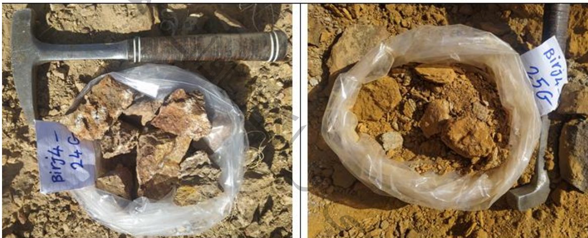
شکل ۵- ۶۴- نمونه های مینرالیزه Birj4-G1 مالاکیتی و آزوریتی در واحد گدازه های آندزیتی حلوایی
