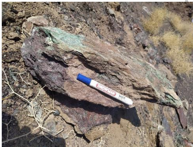
شکل ۵-۴۰- نحوه برونزد وافق شیستی مالاکیت دار در تارگت اکتشافی قنادان زون کلاته حسن (دید رو به شرق)
