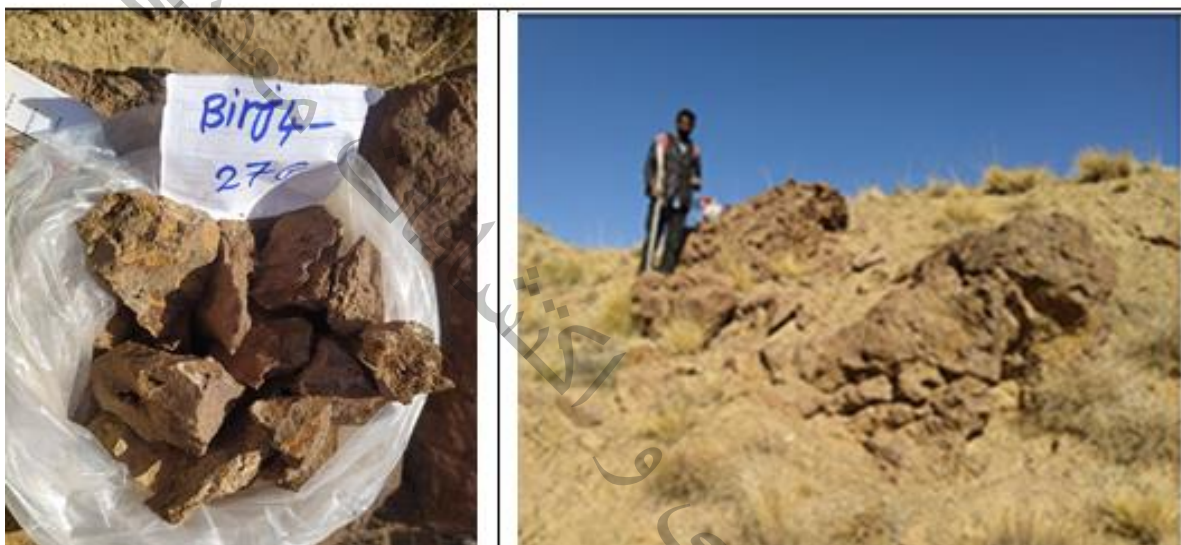
شکل ۵-۶۷- نمونه های مینرالیزه لیسونیت و الترامافیک مالاکیت دار نودر
