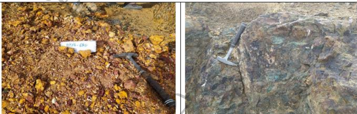
شکل ۵-۶۱- نمونه های مینرالیزه سیلیسی - گوتیتی - لیمونیتی در واحد اولترامافیک از کار قدیمه همواری عباسعلی
