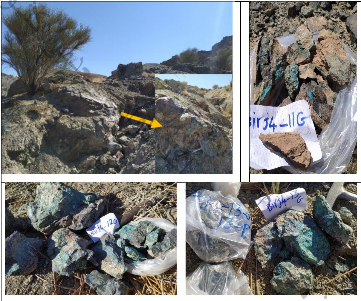
شکل ۵-۱۹- کانی سازی مس، آهن، نیکل و طلا با شواهدی از کانی های کلریت، مگنتیت، مالاکیت آزوریت در سنگ های دونیت و سرپانتینیت تارگت اکتشافی نوکند- گیوک زون نوکند (دید رو به غرب)
