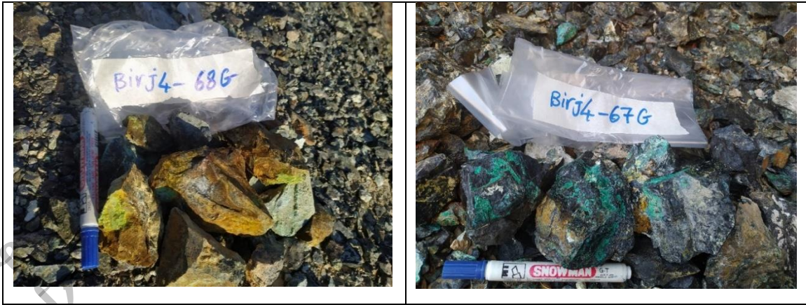
شکل ۵-۶۰- نمونه های مینرالیزه سیلیسی - گوتیتی مالاکیت دار در واحد سرپانتینیت مربوط به کار قدیمه گیوک بالا
