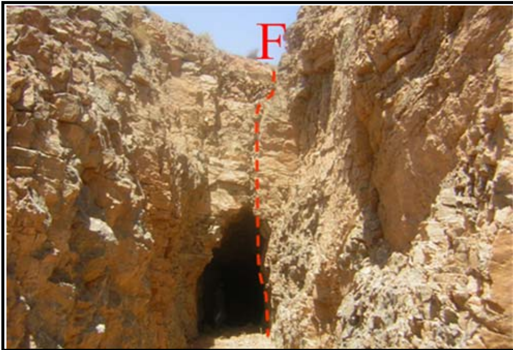
تصویر ۶- نمایی از تونل استخراجی شماره ۱ در محل معادن سه درخت؛ لایه بندی سنگ آهک و راستای گسل در عکس دیده می شوند.
