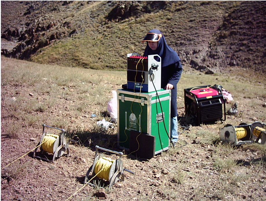
تصویر شماره ۶- مجموعه موتور ژنراتور و ترانسمیتر به همراه سیمهای فرستنده جریان
