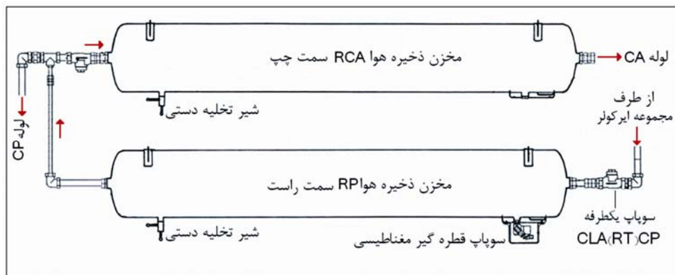
شکل ۳-۱. مخازن ذخیره هوا
