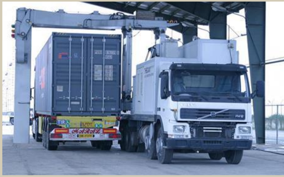
شتاب‌دهنده خطی الکترونی مورد استفاده در گمرک
