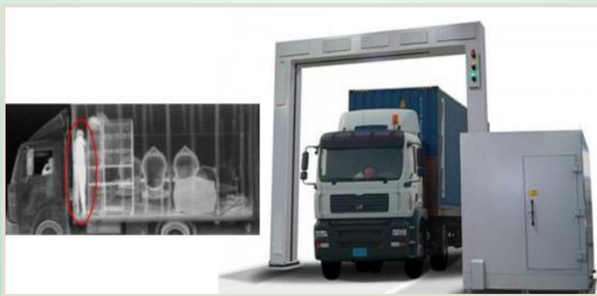
با عبور کامیون از زیر دستگاه تصویربرداری می‌توان داخل کامیون را مشاهده کرد
