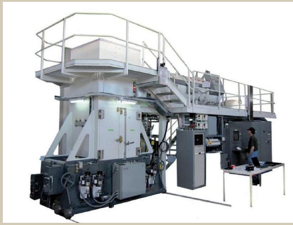
شتاب‌دهنده صنعتی الکترون با انرژی ۸۰۰ کیلوالکترون ولت جهت پرتو دهی کابل
