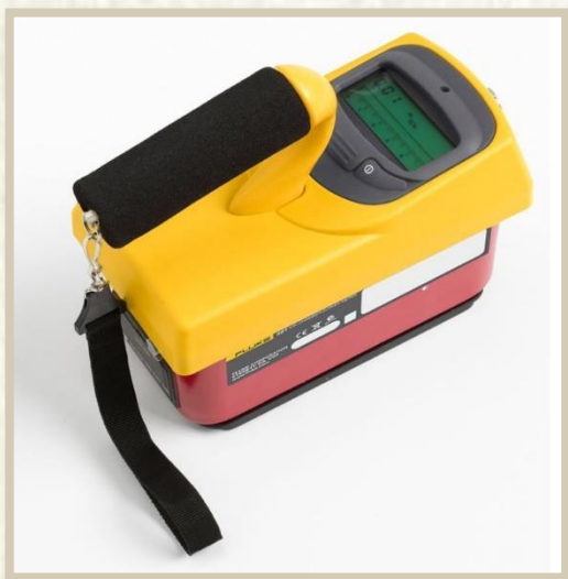
آشکارسازهای پرتو از نوع گایگر مولر
