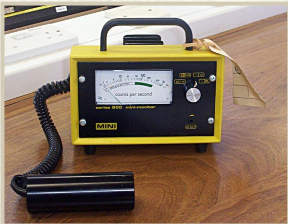
آشکارسازهای پرتو از نوع گایگر مولر
