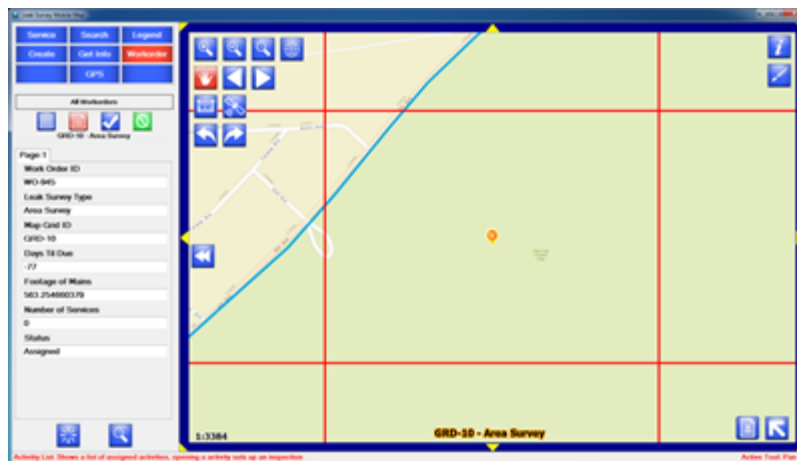
شکل ۱-۲۲- نمایش از اپلیکیشن موبایل نشت یابی گاز
