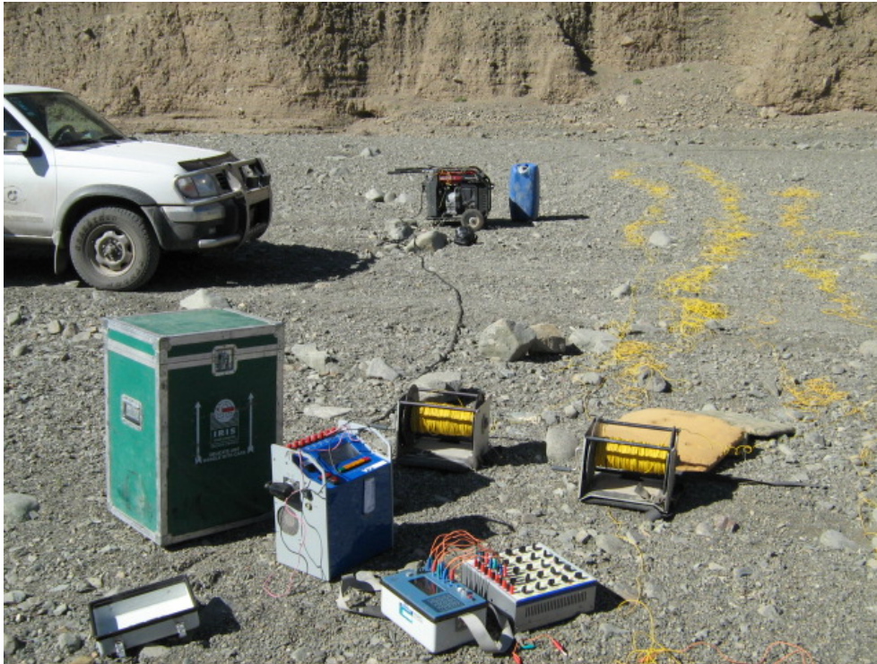
تصویر ۲-۲: مجموعه موتور ژنراتور، ترانسسمیتر و رسیور به همراه سیمهای فرستنده جریان
