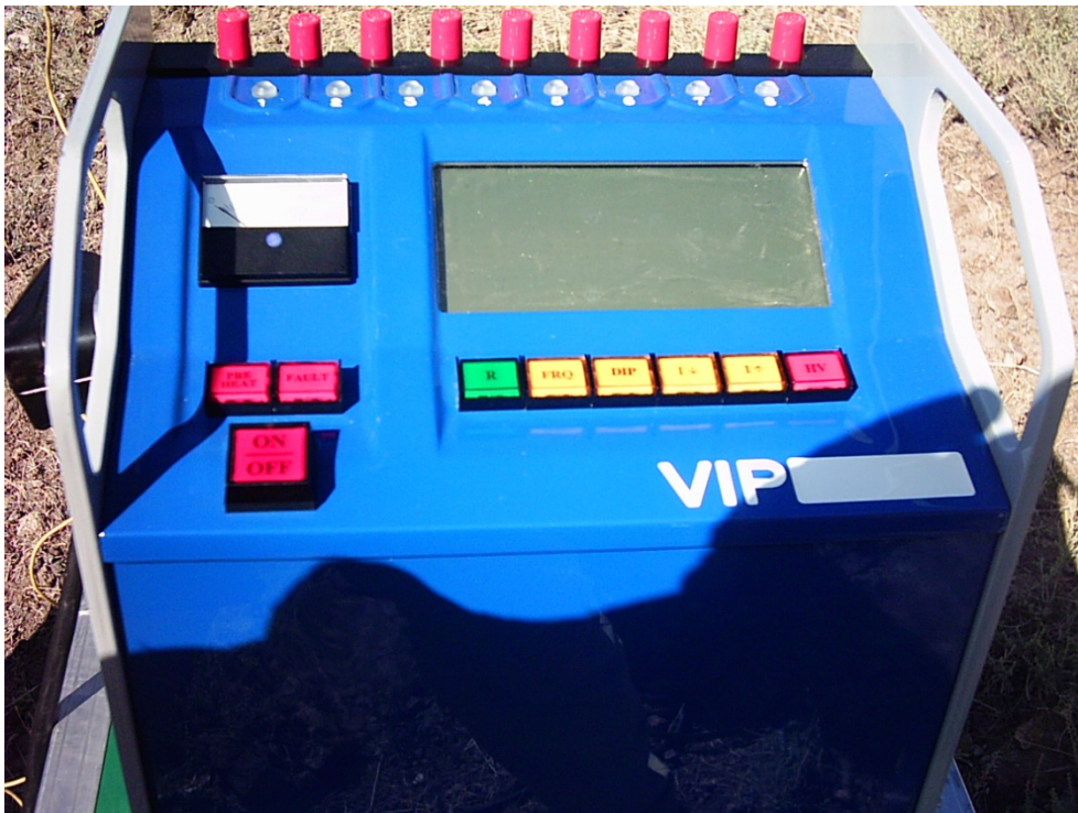
تصویر شماره ۲-۳: ترانسسمیتر VIP ساخت شرکت IRIS فرانسه
