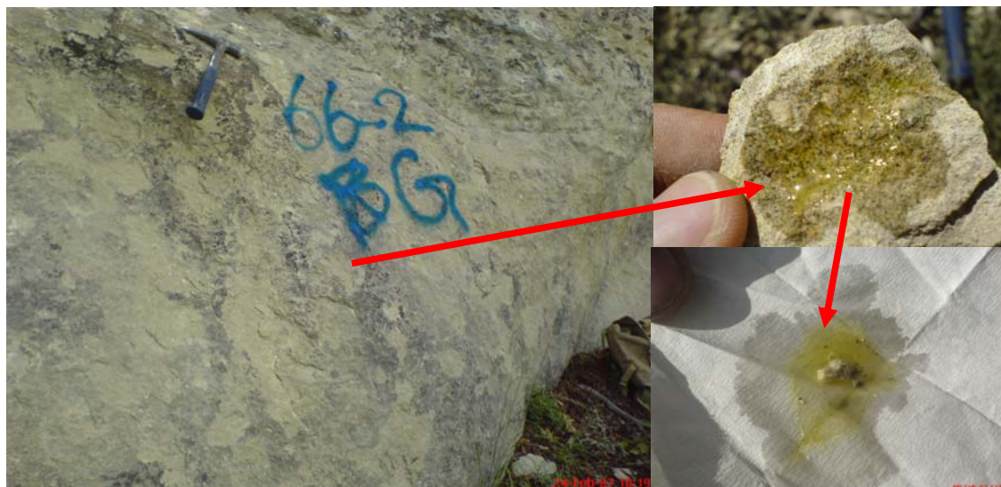
تصوير ۳-۴۰- آهک مارني گلوکونيت دار- گلوکونيت در آهک مارني با تراکم بالای گلوکونيت
