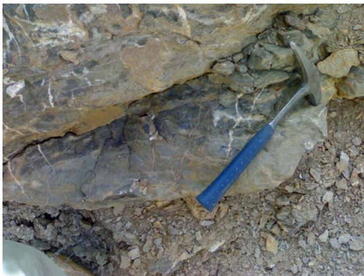
تصویر ۳-۵۹- آهک متوسط لایه تیره فاقد فسيل و با رگچه‌های کلسیتی در انتهای پیمایش ۴۸
