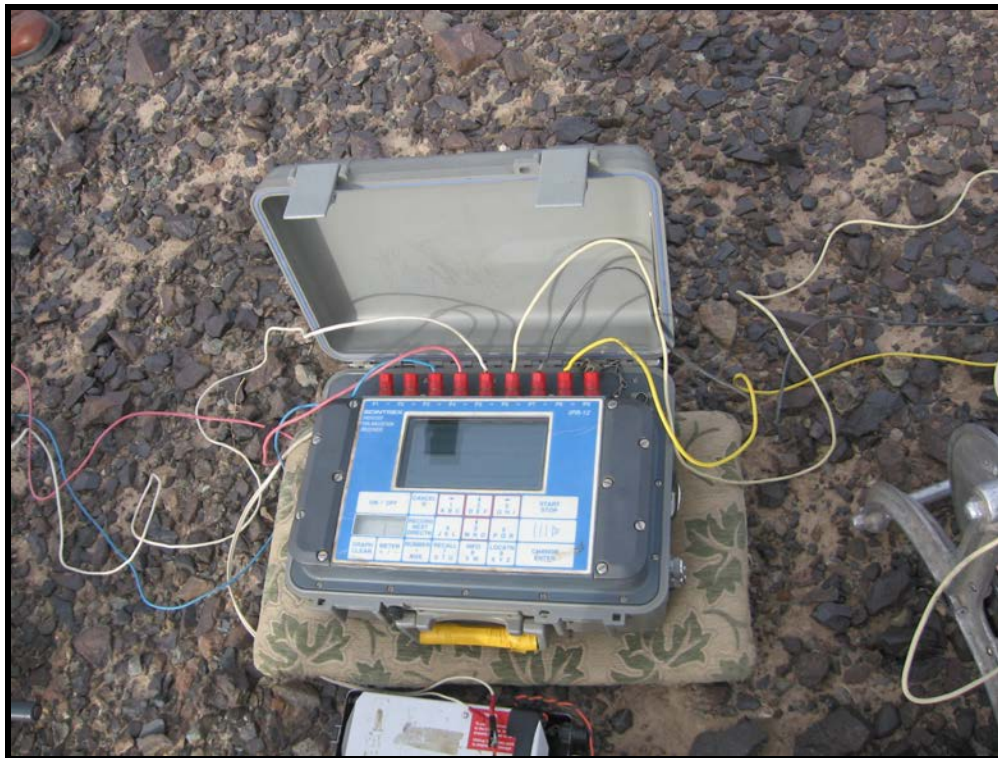
تصویر ۳- گیرنده (رسیور) IPR12 ساخت شرکت سینترکس کانادا
