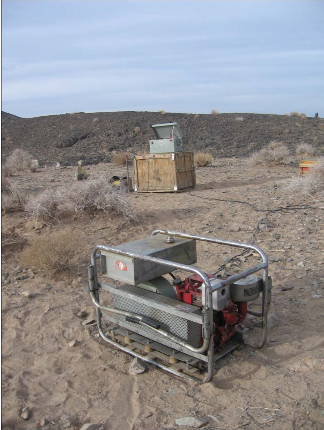
تصویر ۱- مجموعه موتور ژنراتور و ترانسمیتر به همراه سیمهای فرستنده جریان
