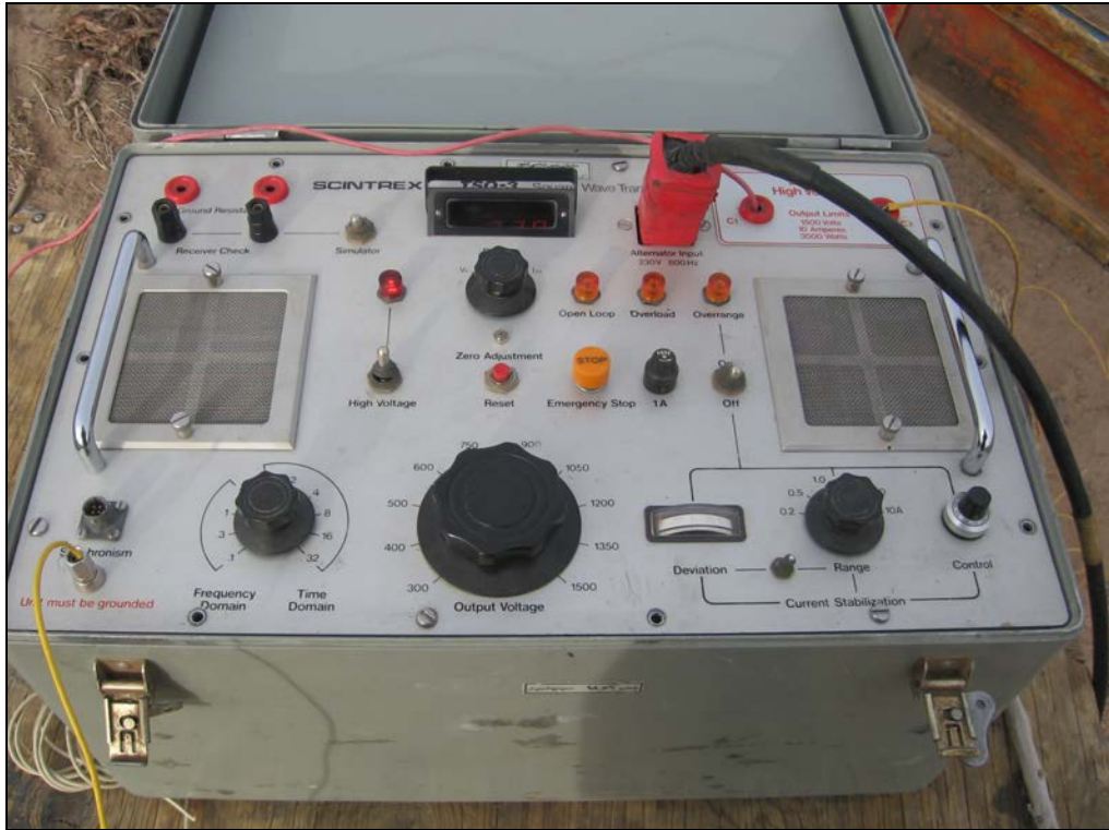
تصویر ۲- ترانسmitter 3-TSQ ساخت شرکت سینترکس کانادا
