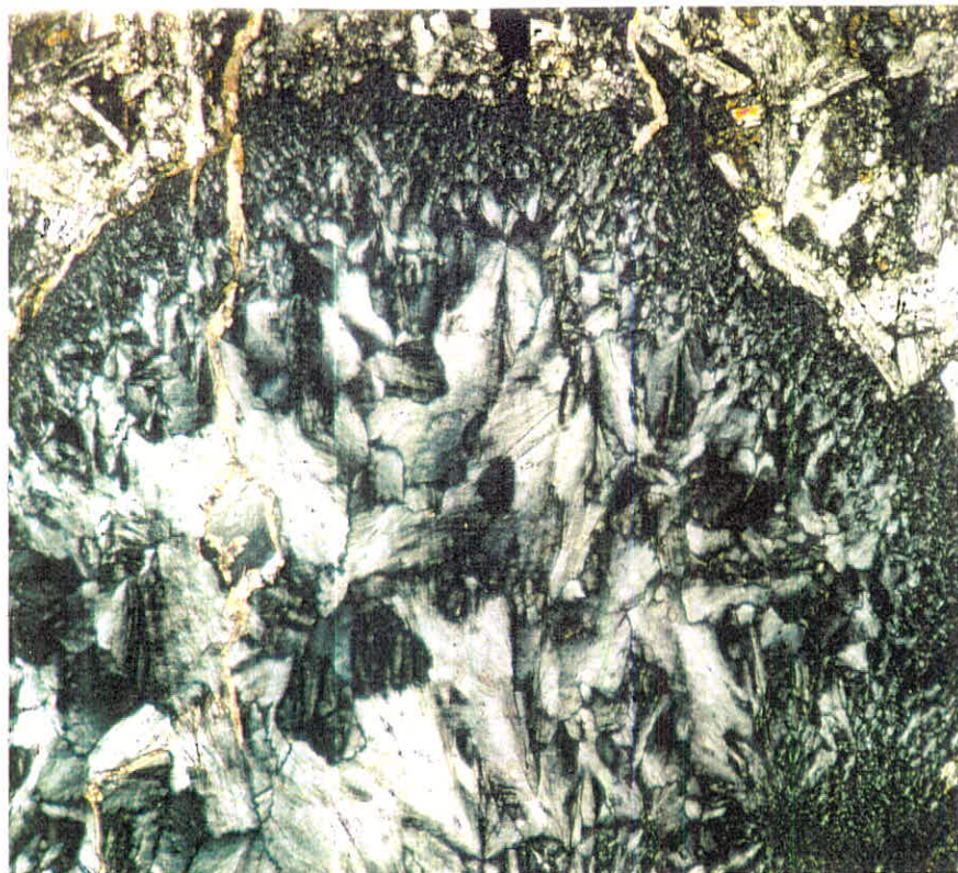
تصویر شماره ۲ - ۲۸: عکس از نمونه شماره 79-GK-PO1 حفره های کلریتی در زیر نور پلاریزه،
