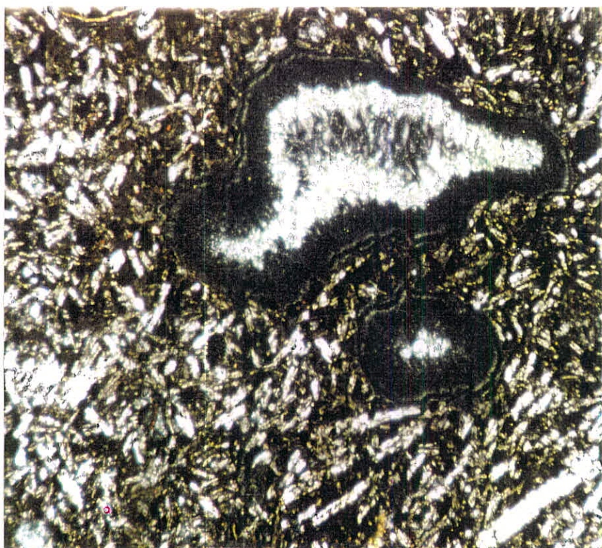
تصویر شماره ۲-۳۱: عکس از مقطع A-80-P17 در زیر نور پلاریزه. حفره کلریتی در زمینه میکروولیتی (بازرگنمایی ۱۰×۴)
