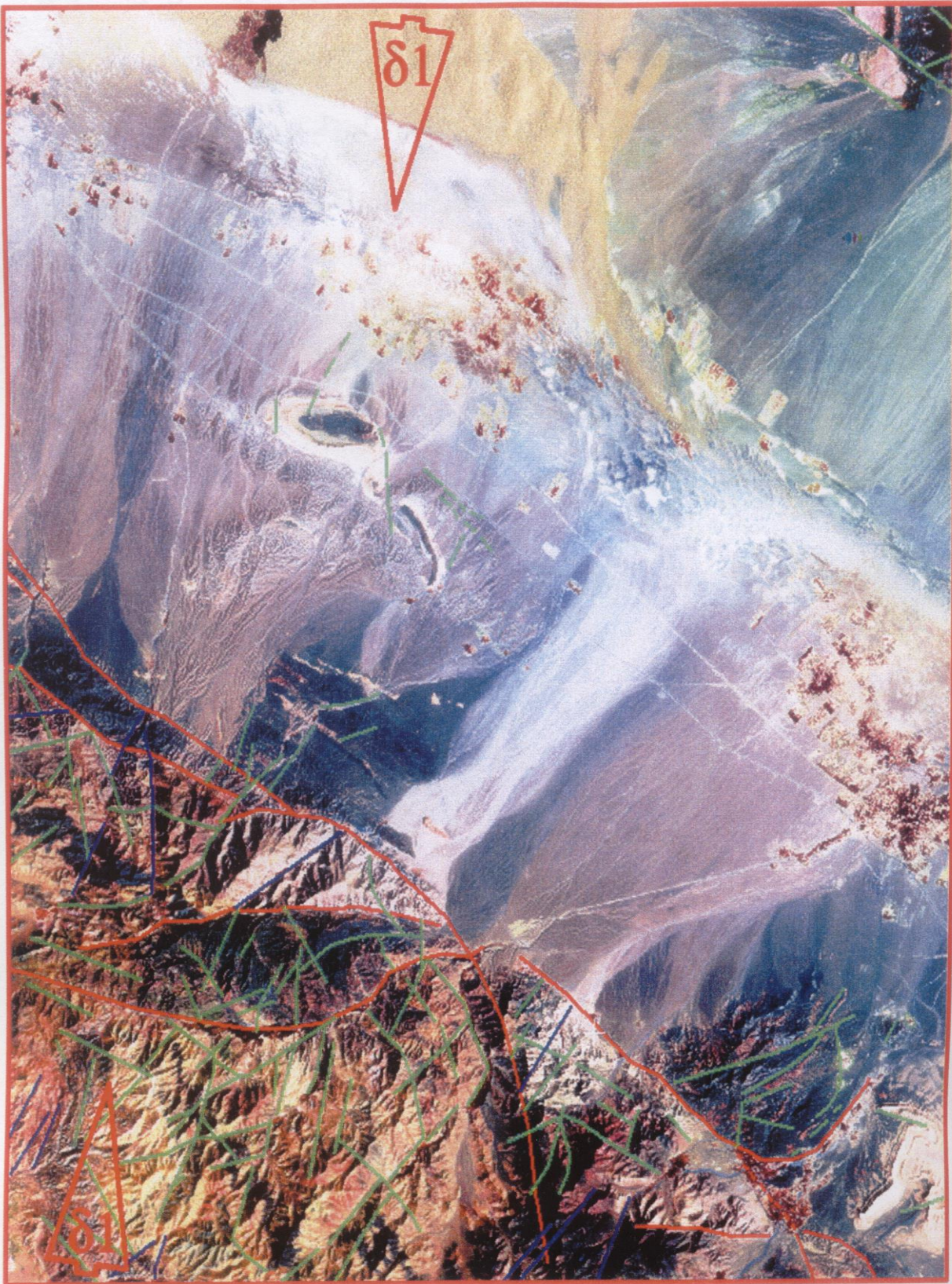
تصویر شماره ۲۷: تصویر ماهواره ای از شکستگیهای ورقه نطنز و جهت تنش اصلی در این ناحیه.
