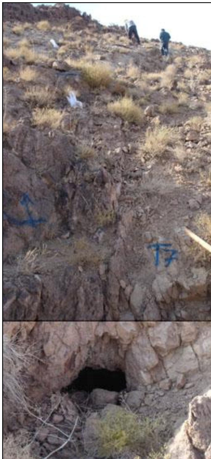
تصویر شماره ۱۱: نمایی از دهانه تونل T7 و رگه لیمونیتی و هماتیتی و ادامه این اکسیدها در سطح زمین. (دید
