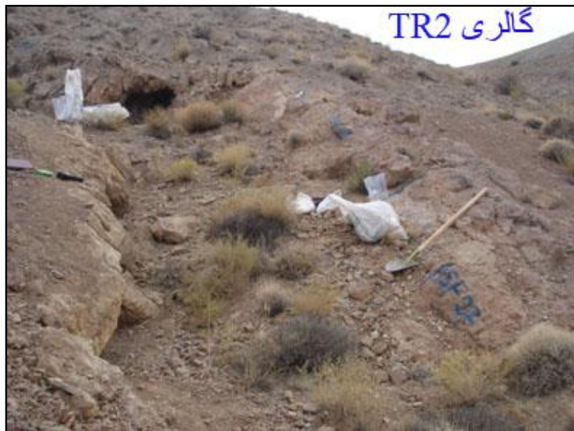
تصویر شماره ۱۲: نمایی از گالری استخراج TR2 که به شکل ترانشه و در امتداد لایه بندی حفر شده است. (دید
