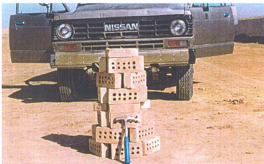
شکل 35-5 آجر خام تولید کارخانه آجر رسه
