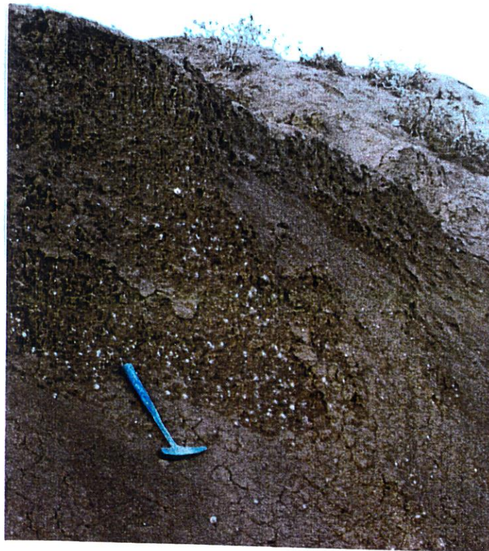
شکل ۳۳-۵ ذرات و قطعات آهکی در متن مارن قرمز رنگ آغاچاری در سینه کار استخراجی معدن خاک کارخانه آجر دژ
