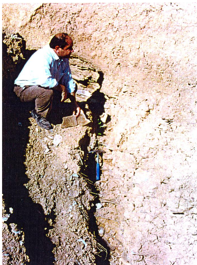
شکل 5-14 و فور رگچه های گچ ورقه های گچ در مارن های قرمز رنگ سازند آغاچاری در منطقه خیرآباد بهبهان
