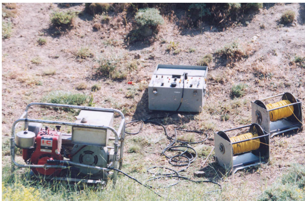
شکل ۵-۱- تصویری از موتور برق مولد نیرو و ترانس TSQ-3 و قرقره های مربوطه
