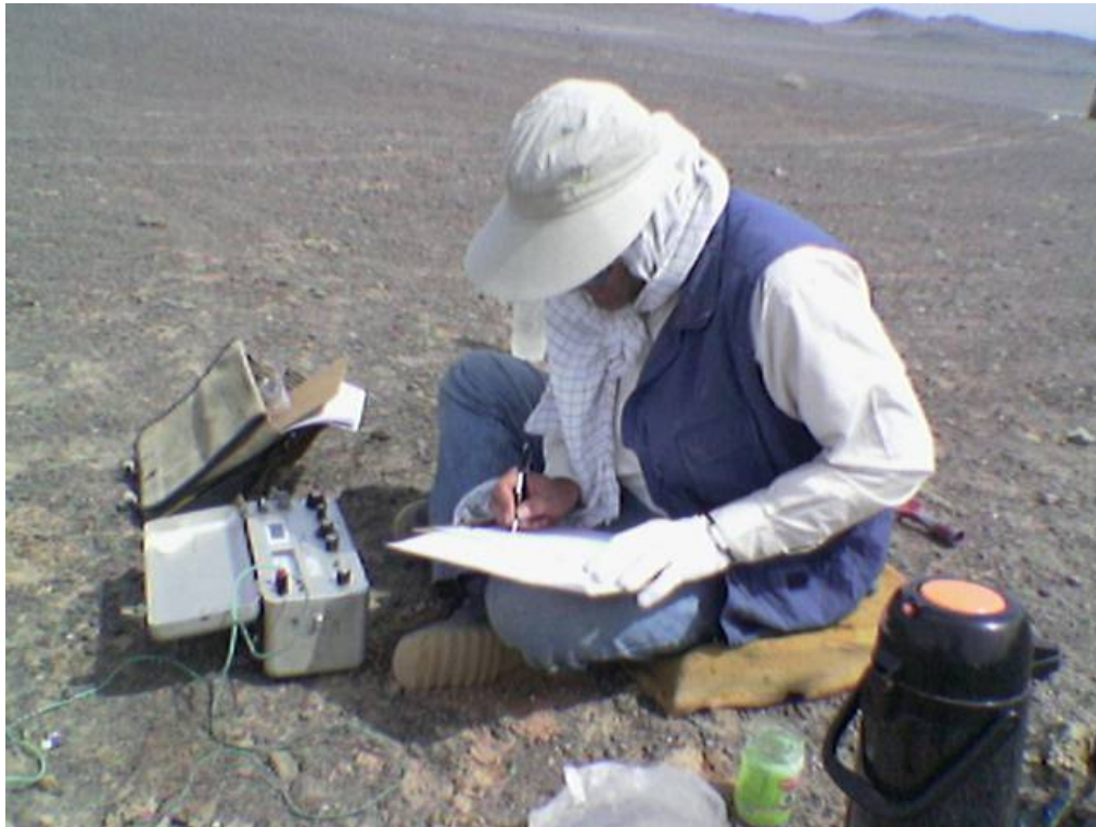
شکل ۵-۴- تصویر از دستگاه گیرنده IPR-10 و عملیات برداشت ژئوفیزیکی
