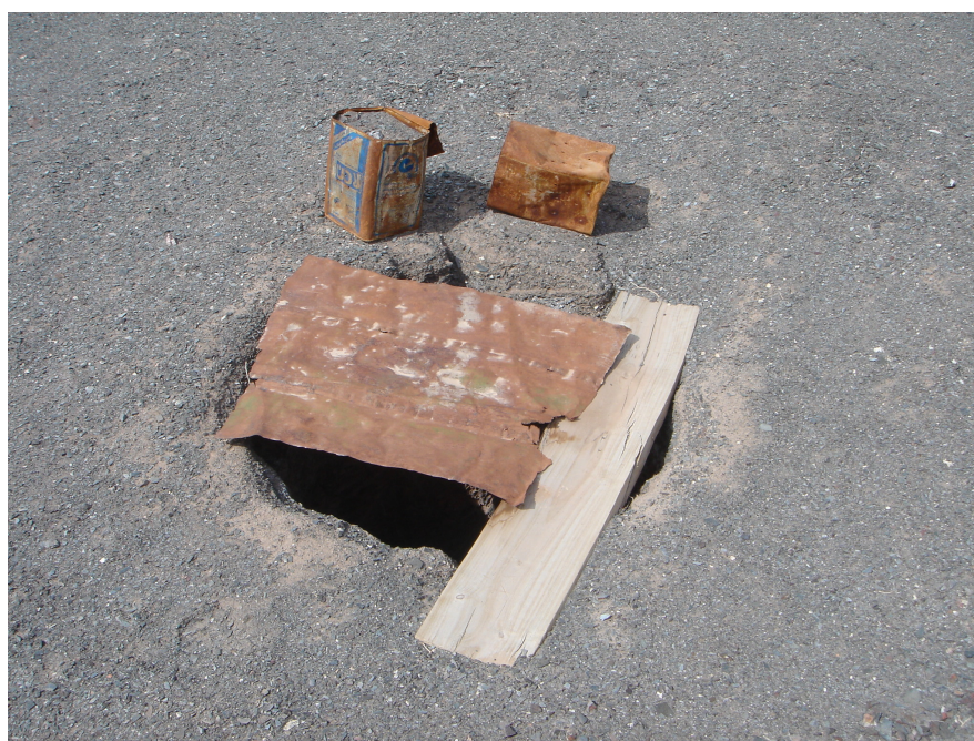
شکل ۱۳-۵-نمایی از دهانه چاهکی که تا عمق ۶/۵ متری در ایستگاه ۴۲۰ در پروفیل ۲۰۰ حفاری شده است.
