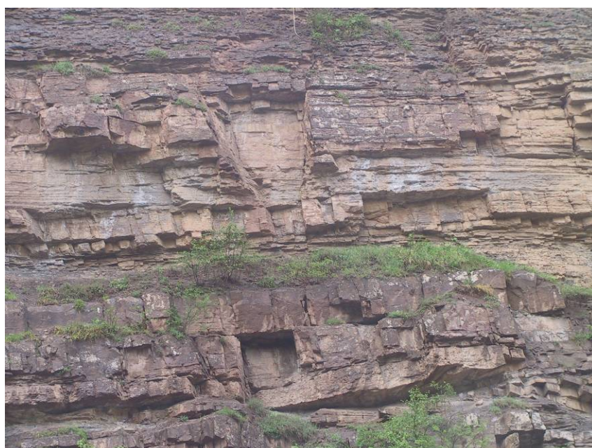
عکس شماره ۹-۴- نمای عمومی دامنه ماسه‌سنگی درود (S40) که با دارا بودن SMR برابر با ۵۴ و پتانسیل رخداد احتمالی ناپایداریهای گوه‌ای و صفحه‌ای به نگهدارنده‌های کاملی جهت افزایش پایداری نیاز دارد.
