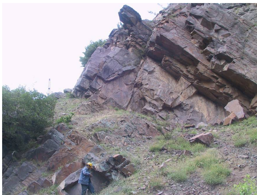
عکس شماره ۴-۲۲- نمای عمومی توده‌های ماسه‌سنگ کهر که در بالادست دامنه فورش سنگی واقع گردیده‌اند. از آنجا که بلوک‌ریزی در آنها بزرگ مقیاس است می‌تواند موارد ناپایداری را ایجاد نماید.
