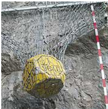
شکل ۵-۲- نمونه ای از توری های فبری سنگ گیر که به صورت افقی بر روی جاده کشیده می شوند و قابلیت نگهداری بلوک هایی تا وزن ۹۶۴۰ کیلوگرم را به صورت سقوط آزاد دارا می باشند.
