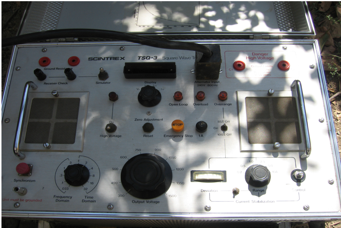
شکل ب - دستگاه ترانسیمتر TSQ-3
