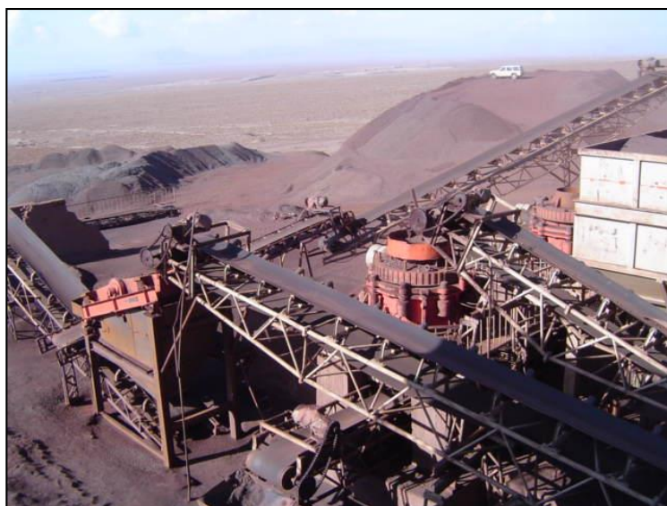
شکل ۲-۵۴- نمایی از نوار نقاله‌ها و سایر دستگاه‌های بخش خردایش کارخانه سنگ آهن سنگان
