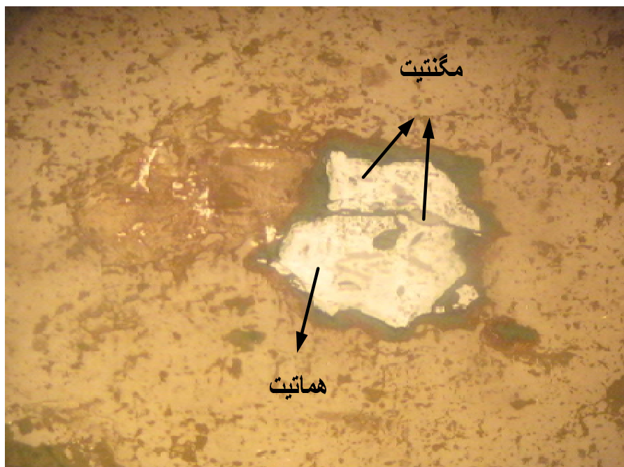
شکل ۴-۲۴ تبدیل شدگی از مگنتیت (خاکستری) به هماتیت (سفید) در مقطع IP-20-2P - XPL.10X
