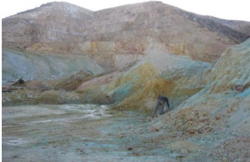
تصویر ۴-۱۹ پیت معدنی و دپوی دره‌زار دارای کانه‌سازی کربناتی مس در ایستگاه IP-14
