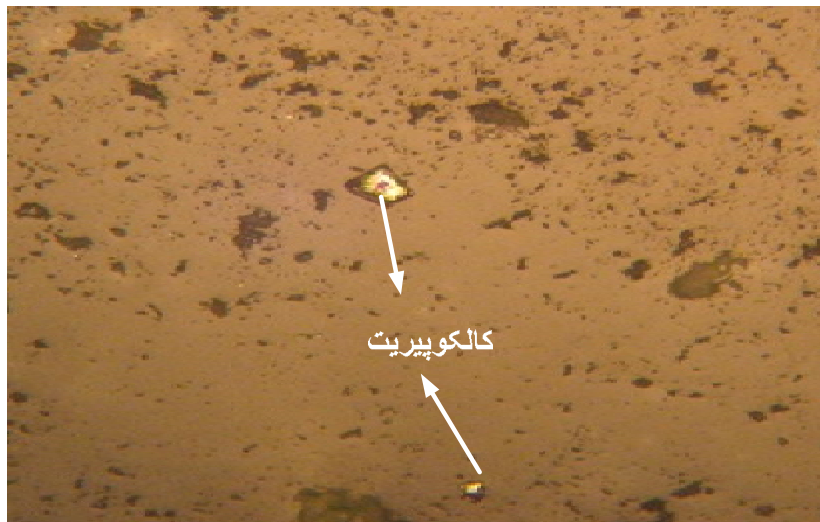
شکل ۴-۱۱۸ کانی کالکوپیریت ریزدانه در مقطع XPL.10X- IP.80.3P
