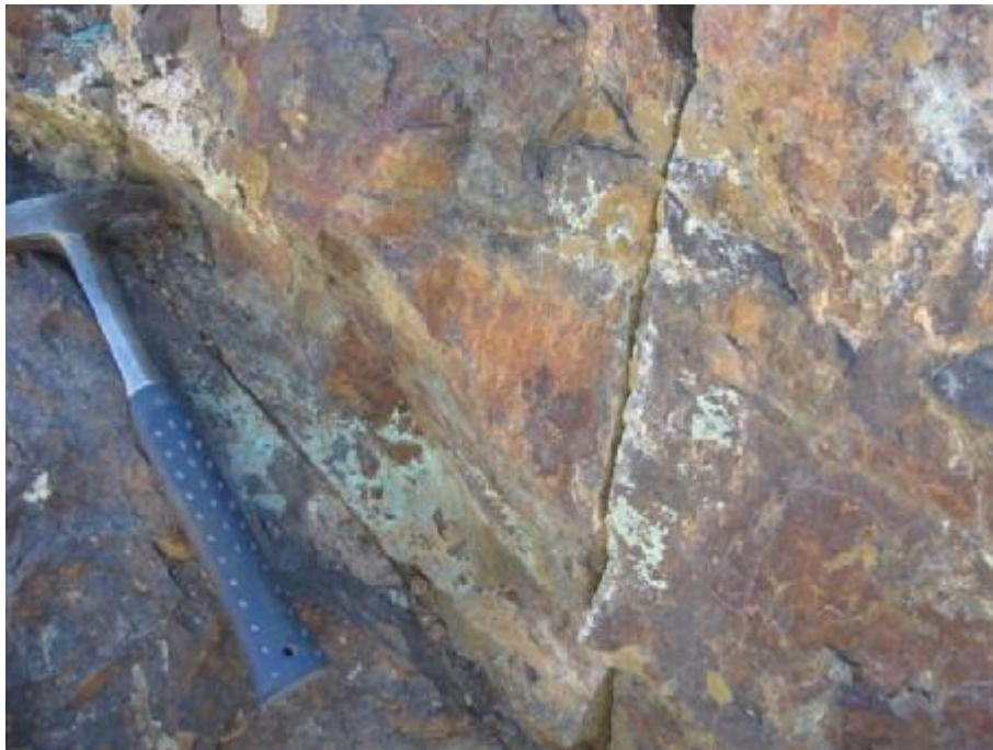
تصویر ۴-۱۰ کانه‌سازی مس درون شکستگی‌های زون‌های سیلیسی - لیمونیتی در ایستگاه IP-6
