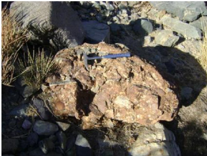
تصویر ۴-۷۹ رگه های سیلیسی - لیمونیتی دارای طلا در ایستگاه IP- 58 در بخش هایی از رگه برش هیدروترمال
