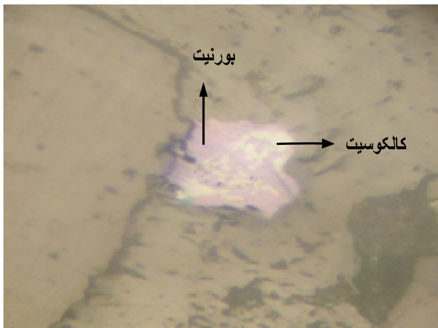
شکل ۴ - ۴۳ بورنیت (صورتی) در حال تبدیل به کالکوسیت (سفید) در مقطع XPL.10X-IP.36.2P
