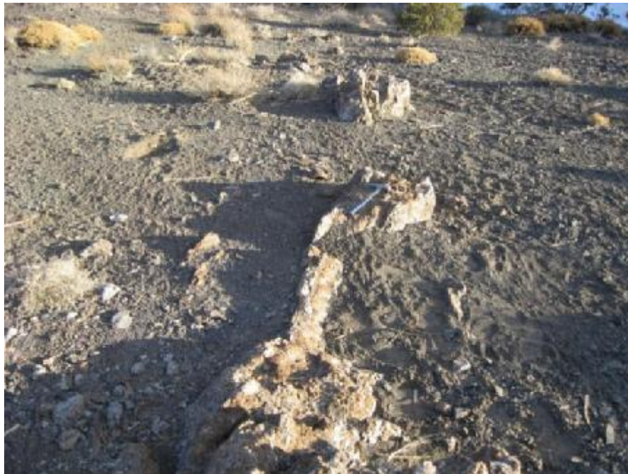
تصویر ۴-۵ رگه سیلیسی دوم حاوی مالاکیت و دیگر کانی‌های مس‌دار در ایستگاه IP-2
