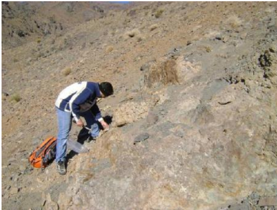
تصویر ۴-۵۴ رگه سیلیسی - لیمونیتی مشکوک به کانه سازی در ایستگاه IP-49
