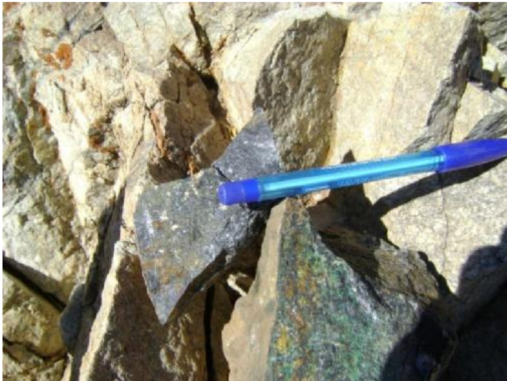
تصویر ۴-۱۰۲ کانه‌سازی مس در همبری دایک سیلیسی واقع در ایستگاه IP-74
