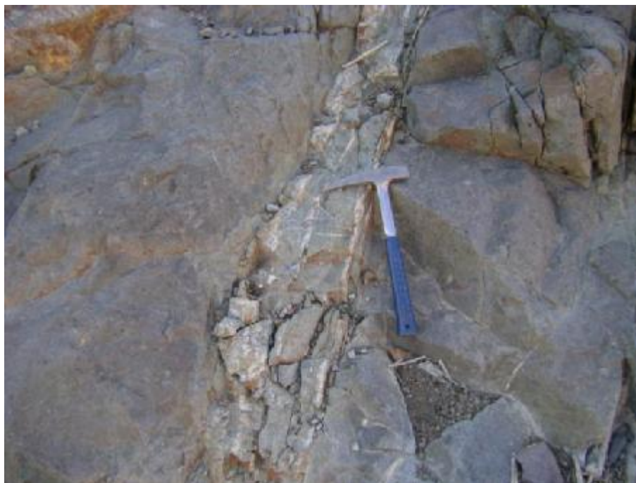
تصویر ۴-۸۲ رگه‌های سیلیسی نازک با میزبان پیروکلاستیک و دارای کانه‌سازی مس و سرب در ایستگاه IP-59
