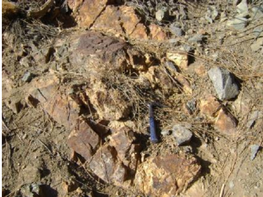
تصویر ۴-۷۸ رگه های سیلیسی - لیمونیتی دارای طلا در ایستگاه IP- 58
