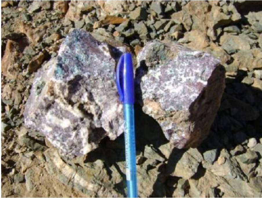
تصویر ۴-۹۹ کانه‌سازی مس درون ژاسپ واقع در ایستگاه IP-73
