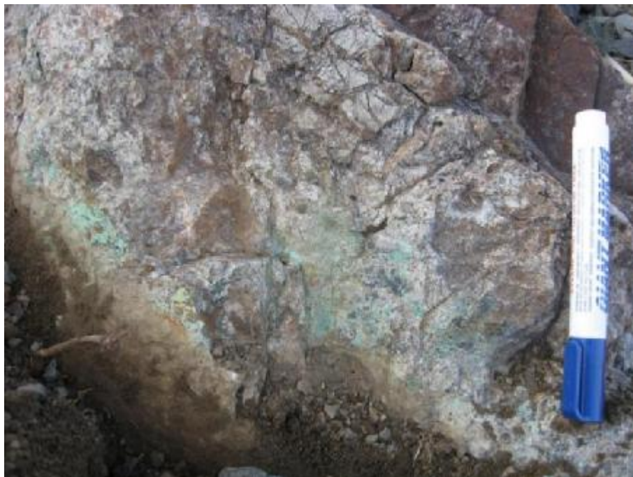
تصویر ۴-۶ کانه سازی مس اغلب به صورت مالاکیت در متن رگه‌های سیلیسی موجود در ایستگاه IP-2
