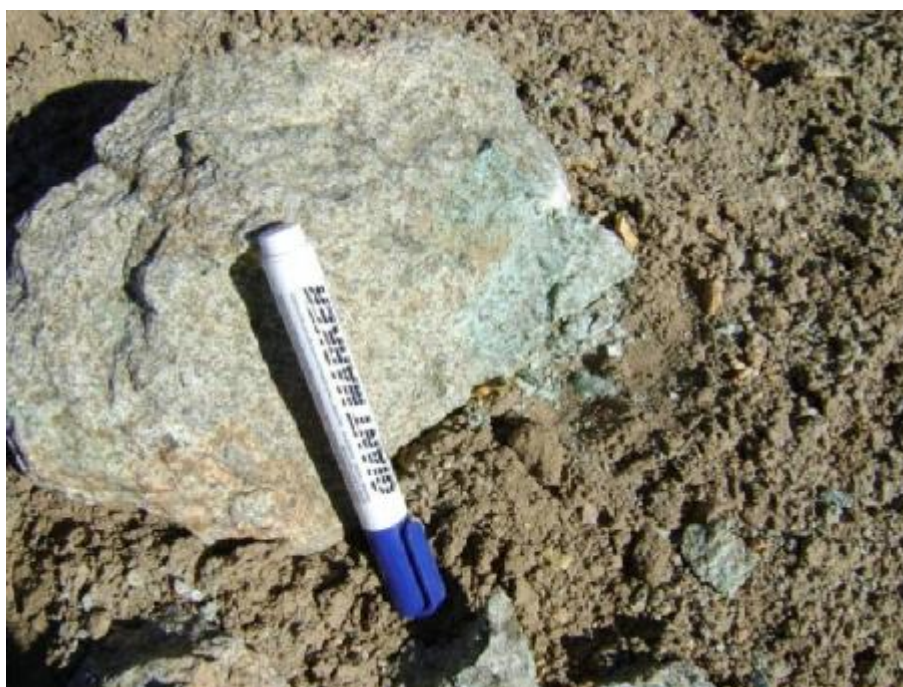
تصویر ۴-۸۶ آثار کانه‌سازی مس در میزان آندزیتی واحد نفوذی سیلیسی در ایستگاه IP- 61
