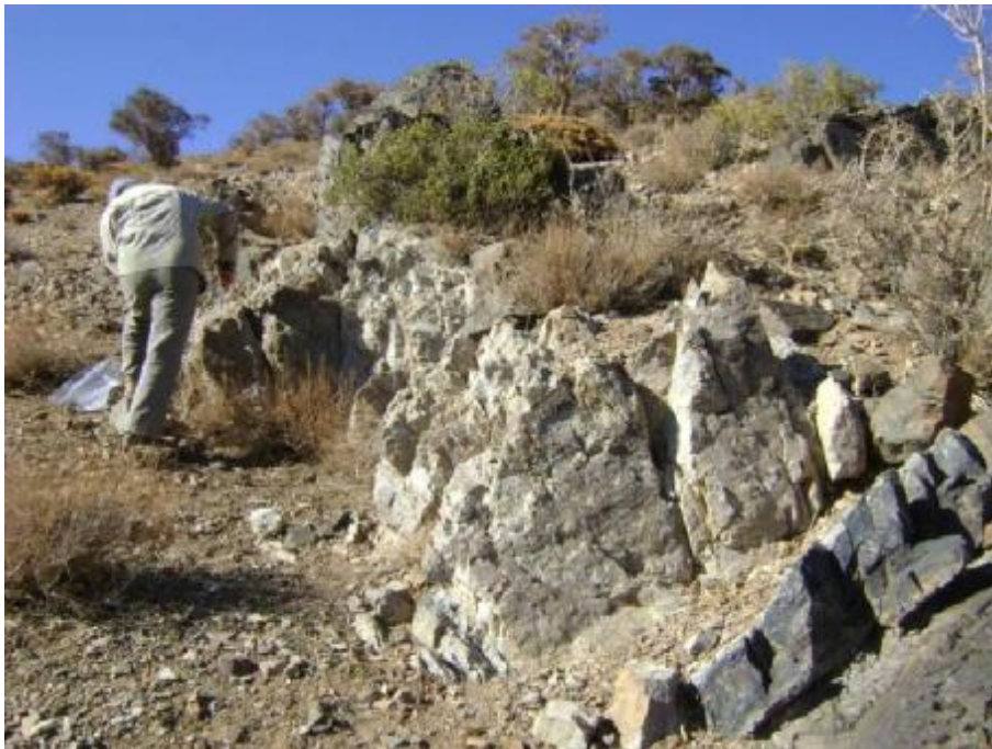
تصویر ۴-۱۰۱ نمای نزدیک دایک به شدت سیلیسی و کانه دار در محل ایستگاه IP-74
