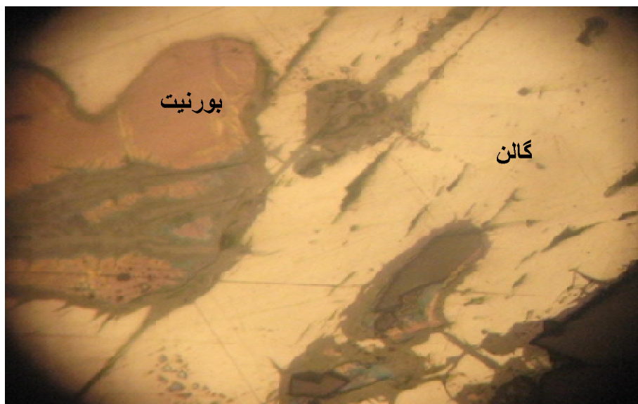
شکل ۴-۴۷ شکستگی پر شده‌ی گالن (سفید) توسط بورنیت (صورتی مایل به بنفش) در مقطع IP.37.2P - XPL.10X
