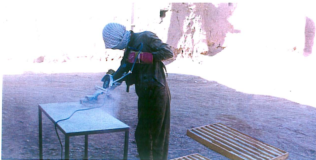
شکل ۴-۱- چگونگی برش مغزه ها برای نمونه گیری شیاری.
