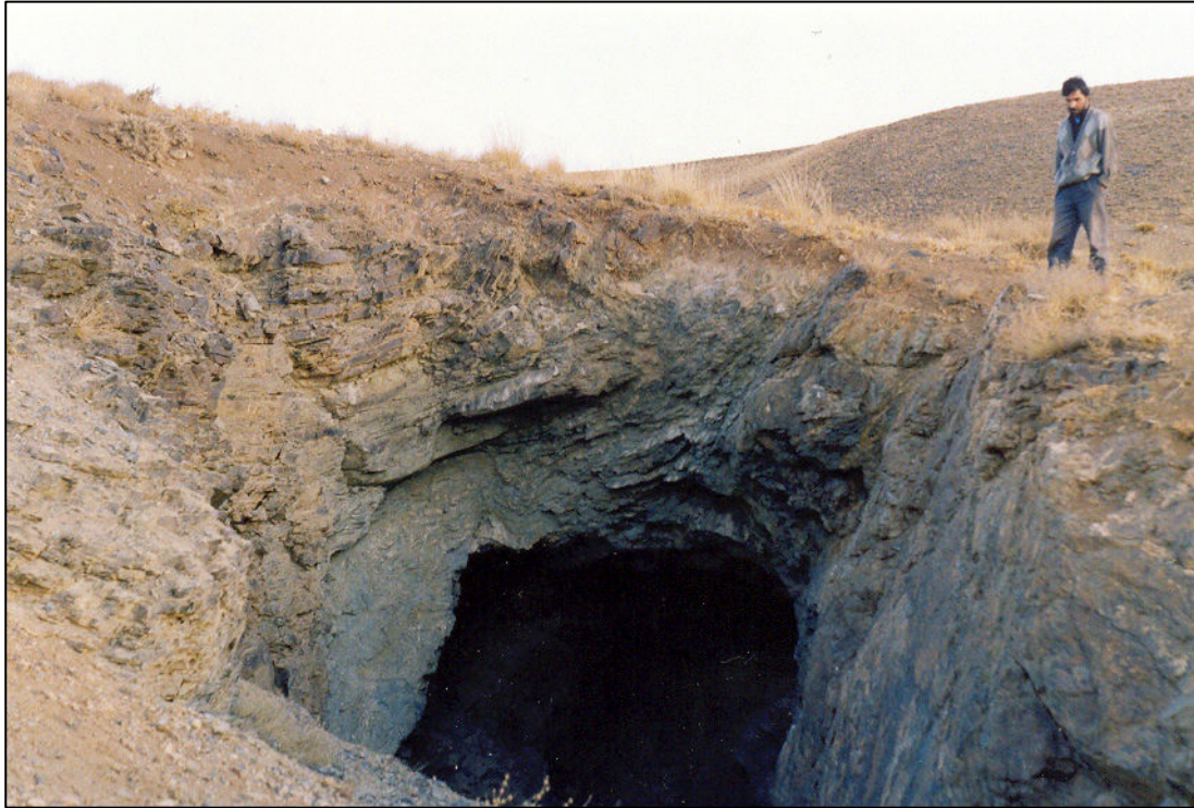
عکس ۱۹- نمایی از یکی از تونل های حفر شده در امتداد گسل واقع در واحد فیلیت - اسلیت کانسار سرب و روی دره احمدخان
