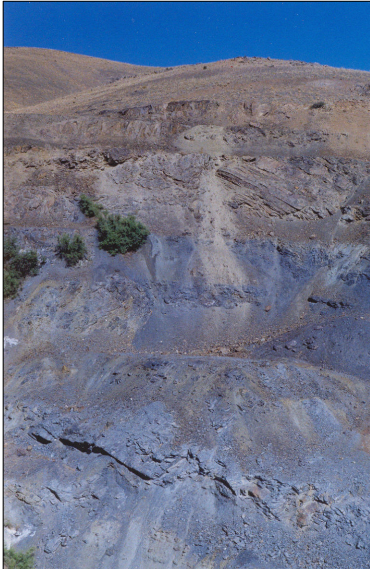
عکس ۱۲ - نمایی از یکی از افق های کانه دار (بخش های خاکستری) کانسار سرب و روی حسین آباد (نگاه به باختر عکس از مهری ۱۳۸۴).
