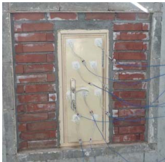
شکل ۴-۴: تصویر ترموکوپل‌های نصب شده بر روی سطح غیر در معرض شیشه سکوریت
