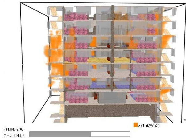
شکل ۵-۳۲: ورود آتش به راه‌پله اختصاصی واحد روبرو
