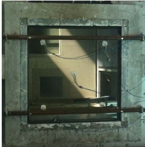
شکل ۴-۴: تصویر ترموکوپل‌های نصب شده بر روی سطح غیر در معرض شیشه سکوریت
