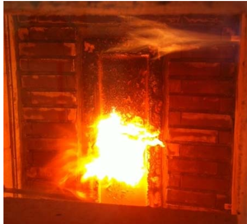
شکل ۴-۱۰: سوختن سطح در معرض (دقیقه ۲)
