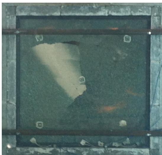
شکل ۴-۹: فرو ریختن شیشه (دقیقه ۸)
