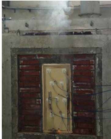
شکل ۴-۱۱: خروج آتش از سطح غیر در معرض و شکست معیار یکپارچگی (دقیقه ۴)
