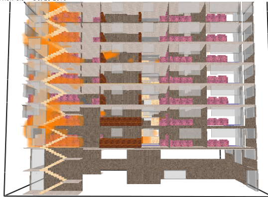
شکل ۵-۲۰: ورود آتش به طبقه ۳
