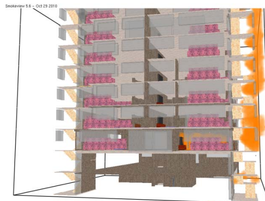
شکل ۵-۱۸: صعود آتش تا طبقه ۶ راه‌پله اختصاصی
