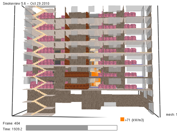
شکل ۵-۳۸: ورود آتش به پلکان عمومی (مسدود شدن راه فرار)
