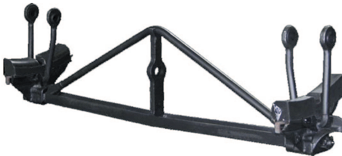
شکل ۲-۶۴) میله مثلث بوژی ۱۰۰-۱۸ به همراه آویزها
