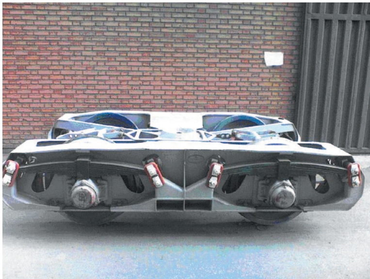
شکل ۲-۸) بوژی H665 تولیدی شرکت واگن پارس (تحت لیسانس wagon union آلمان)
