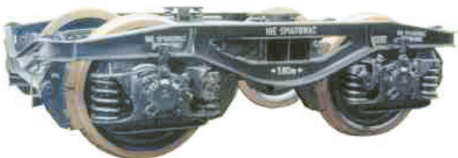
شکل ۱-۲) تصویر یک نوع بوژی باری
