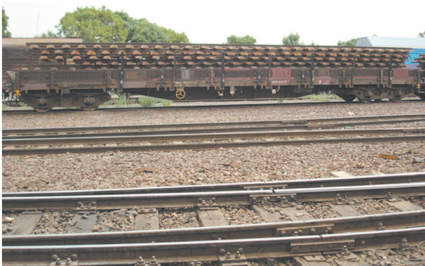
شکل ۱-۳۴) واگن لبه کوتاه مورد استفاده در ایران در حال حمل ریل
