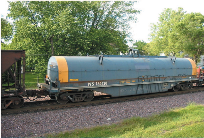
شکل ۱-۱۵) واگن لبه کوتاه مخصوص حمل کویل
