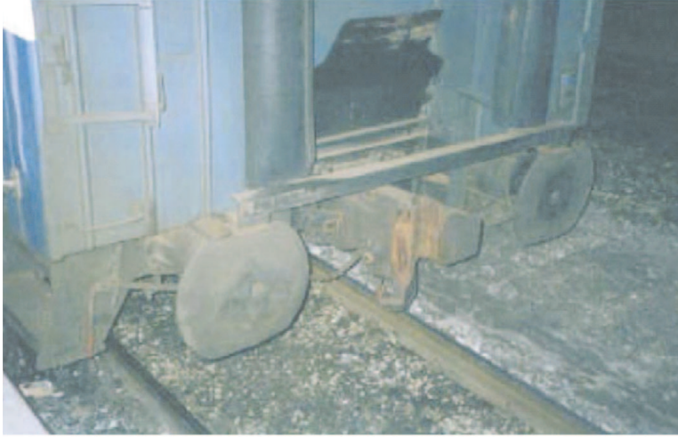
شکل ۱-۶) تامپون که در دو طرف واگن قرار گرفته است
