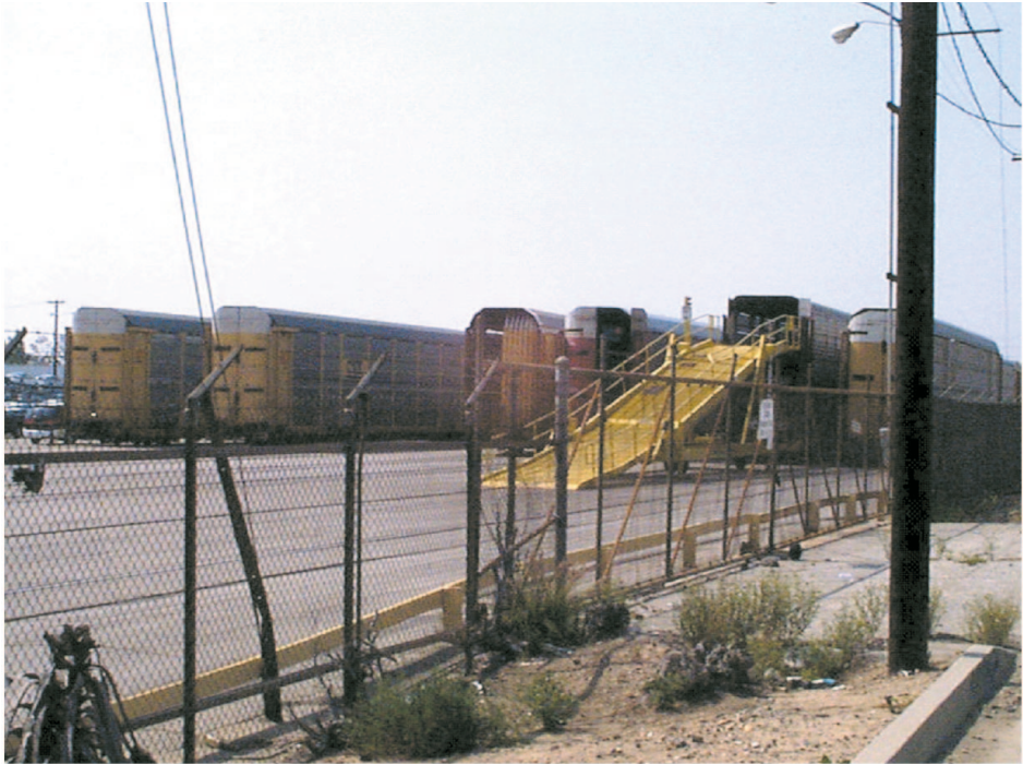
شکل ۱-۲۸) طریقه‌ی استفاده از سطح شیب‌دار برای بارگیری اتومبیل
