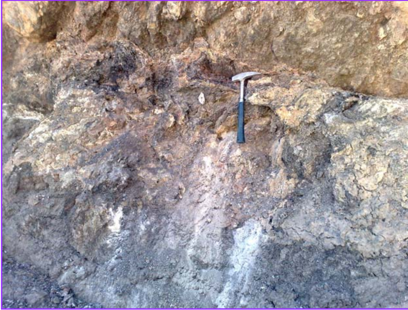
تصویر ۵-۲۵- نمایشی از مکان برداشت نمونه‌ی CL-504 در داخل سنگ آهک و شیست که دارای کانه‌های اکسید آهن می‌باشد.
