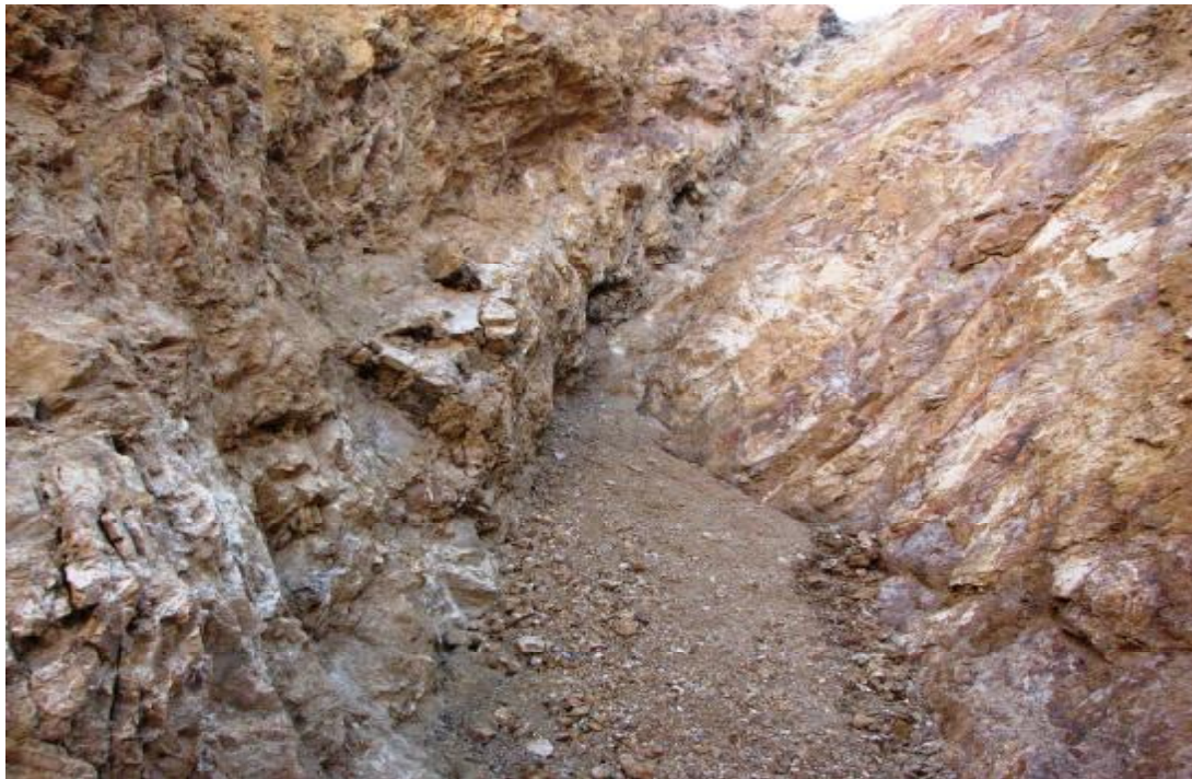
شکل (6-11) نمایی از کانال استخراجی حفر شده جهت استخراج فلورین در معدن هلالی
