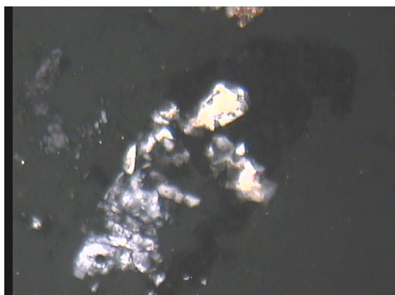
عکس ۱۰- درگیری باریت با کوارتز و فلوریت در نور عادی و با تارهای صلیب در نمونه شماره BK-SI-3 . طول عکس ۹۰۰ میکرون.
