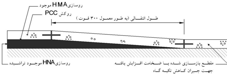
شکل ۱۸-۶: جزئیات نواحی انتقال در محل دسترسی پل و روگذر برای روکش بتنی
