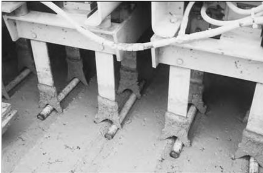
شکل ۱۴-۷: جایگذار میلگردهای اتصال (ACPA 1996a:VI-32)
