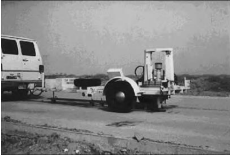
شکل ۱۶-۲: دستگاه خیزسنج وزنه‌ای (عکس از نویسنده)
