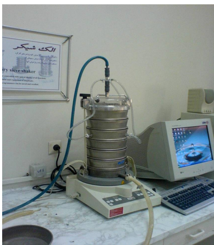
شکل 2-18 دستگاه الک شیکر برای دانه بندی رسوبات به روش مرطوب
