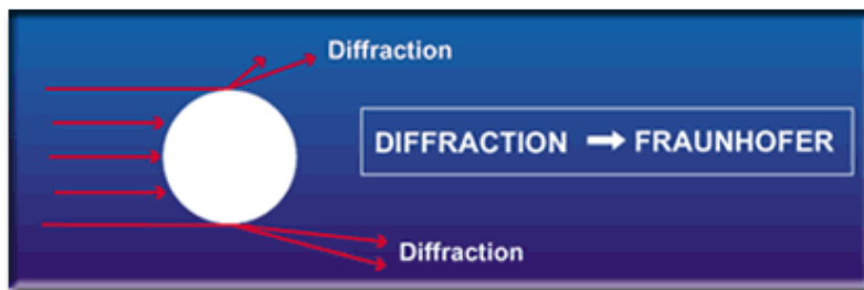
شکل 2-21 استفاده از پدیده پراش (تفرق) فرانهور در اندازه گیری قطر ذرات
