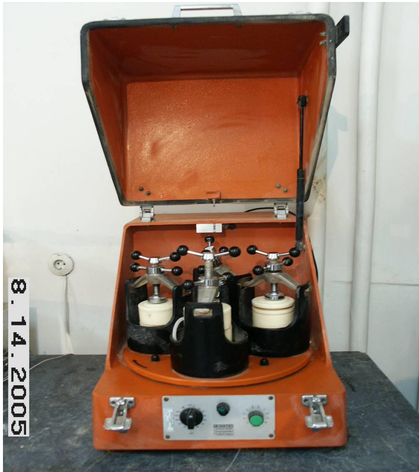
شکل 2-7 دستگاه آسیاب جهت خردایش رسوبات برای آزمایش کلسی متری و ICP
