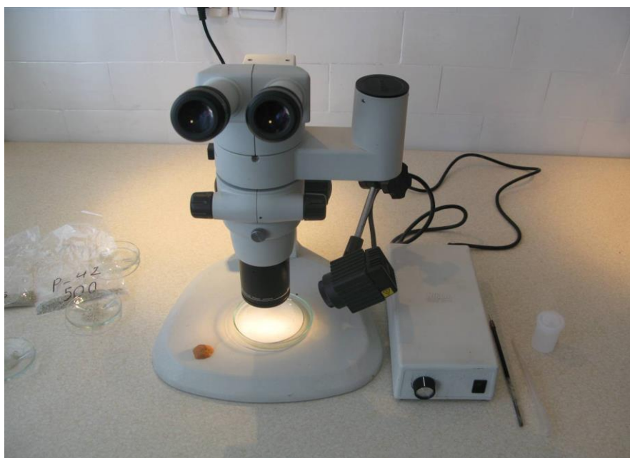
شکل 27-2 مطالعه مورفوسکوپی و مورفومتری کانیها توسط بینو کولر
