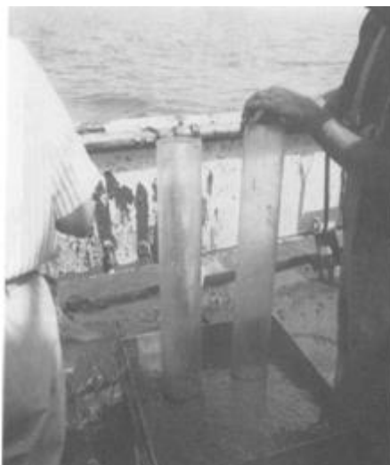
شکل 1-19 طرز مغزه گیری از رسوبات توسط دستگاه مغزه گیر Box
