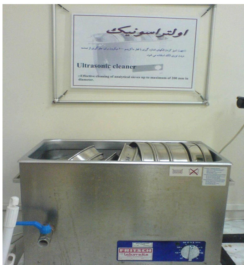
شکل 2-16 دستگاه الترا سوند برای تمیز کردن الکهای ریز واز بین بردن چسبندگی رسوبات
