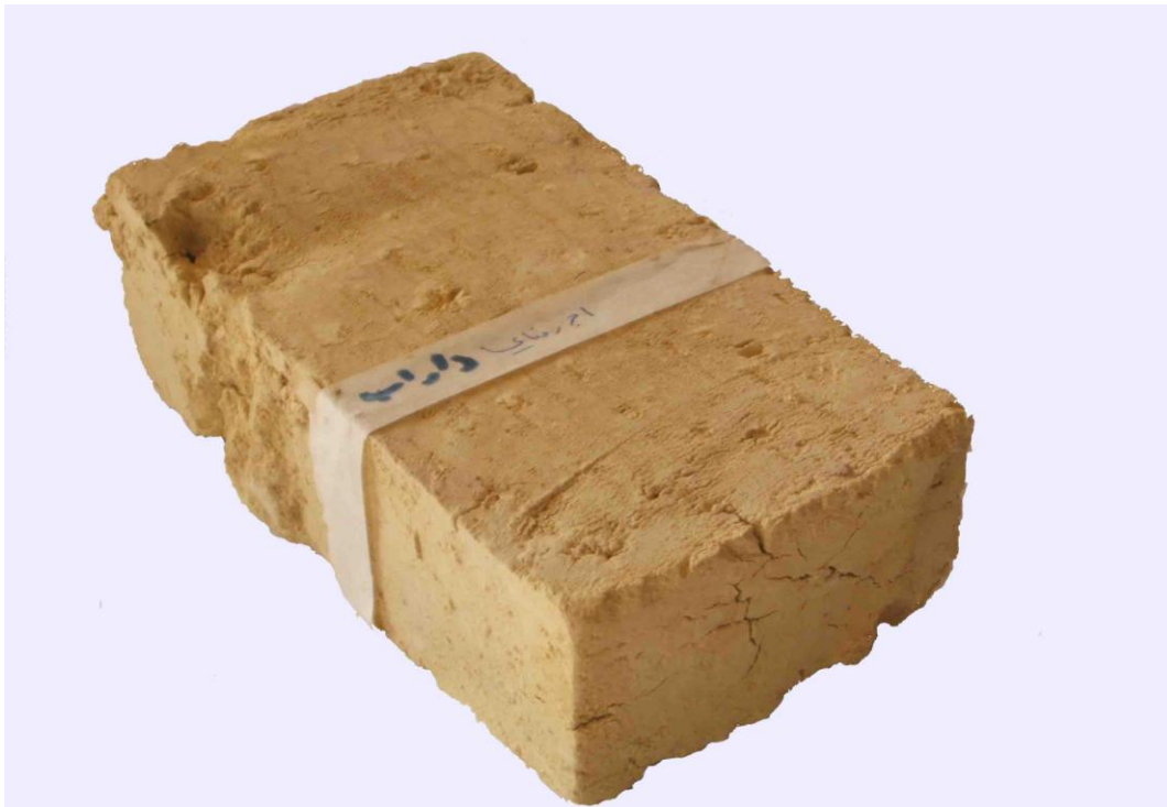
شکل ۸-۹ آجر تولید شده در واحد فعال آجرپزی رضایی داراب (تولید شده از خاک رس).
