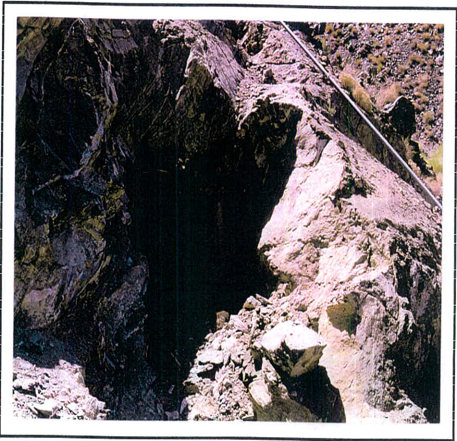
عکس شماره-۸۲: نمائی از تونل دیگر استخراج میکا در دره ملیح آباد، ضخامت لایه در حدود ۵۰ سانتیمتر که میزان ضخامت به طرف عمق تونل کمتر می شود.
