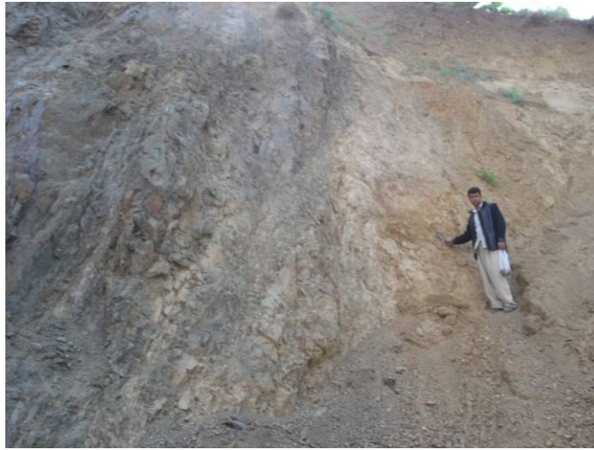
تصویر ۲۳: واحد توف شدیداً خرد شده و هماتیتی- لیمونیتی در محل گسلش (محل نمونه ۱۳۴۶۲m)
