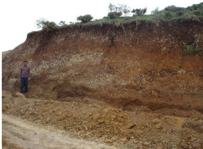
تصویر ۱۶: واحد توف شدیداً خرد شده هماتیتی - لیمونیتی در محل گسلش (محل نمونه M۱۳۳۱۱)
