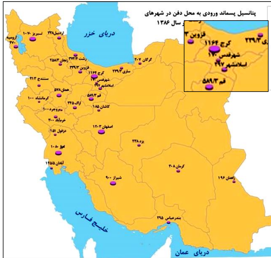
شکل ۱-۱۸- پتانسیل پسماند ورودی به محل دفن زباله (برحسب تن در روز)؛ (وزارت نیرو، سازمان انرژی‌های نو)
