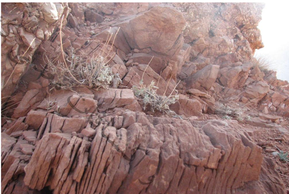
عکس ۱- ماسه سنگهای قرمز سازند فجن ، دارای لایه بندی نازک لایه با میان لایه های رسی ، آثار هوازدگی شدید و رطوبت در آنها قابل مشاهده است.
