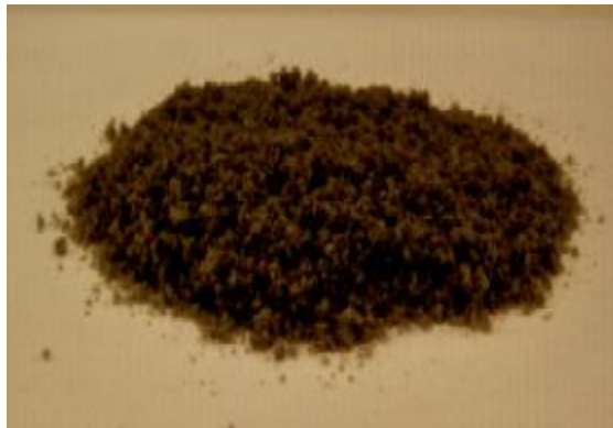
شکل 4-36: ضایعات فوم پلی یورتان استفاده شده و ترکیب شیمیایی اولیه [17]
