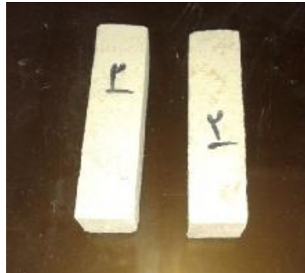
شکل 5-31: آزمونهای ساخته شده برای آزمونهای اندازه‌گیری مقاومت فشاری، چگالی و ضریب جذب آب مؤئینه
