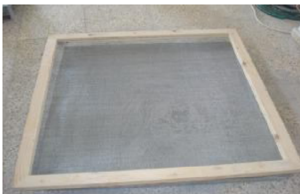
شکل 4-2: الک مورد استفاده برای به دست آوردن اندازه مورد نیاز سنگدانه [15]
