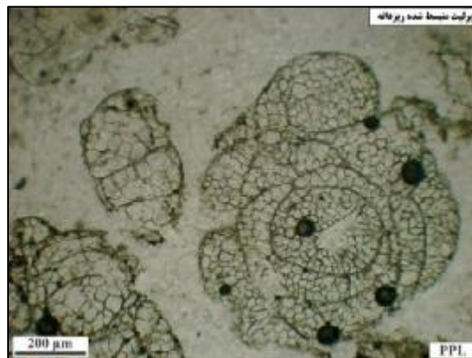
شکل 5-8: تصویری از ذرات پرلیت منبسط ریزدانه در نور موازی که در آن جبهه‌های انبساط و حفره‌های متخلخل ناشی از افزایش حجم به وضوح قابل مشاهده است. در مجموع، خطوط مشاهده شده در بخش‌های مختلف ذرات از جنس شیشه و فضاهای سفید رنگ بین آنها خالی است
