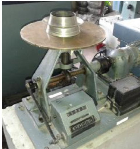
شکل 5-23: تعیین روانی ملات تازه با استفاده از جریان میز
