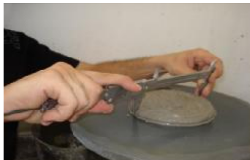
شکل 5-24: اندازه‌گیری قطر جریان ملات تازه توسط کولیس
