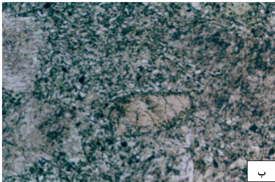
شکل ۲-۱۰- بافت پورفیریتیک ( الف ) و فلتی ( ب ) در سنگهای ولکانیکی ائوسن منطقه مورد مطالعه ( XPL, \times 4 )
