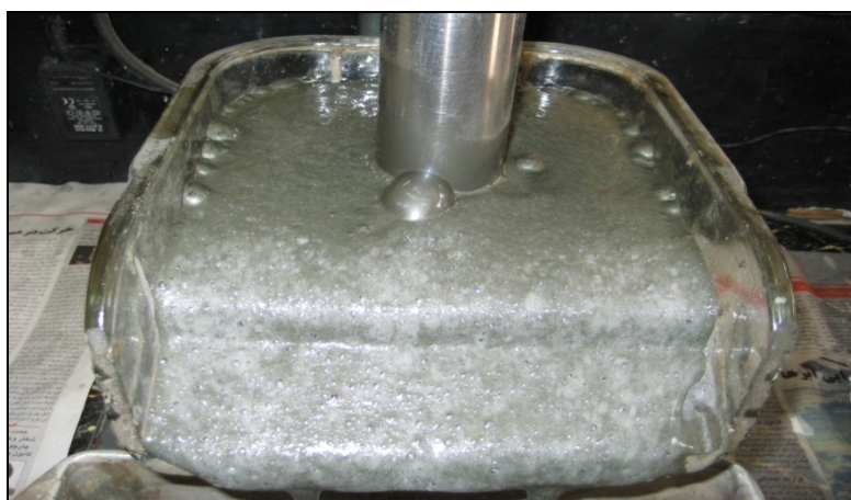
شکل ۳-۱۶: شستشوی (کلینر) مرحله اول آزمایش ۵ کیلوگرمی
