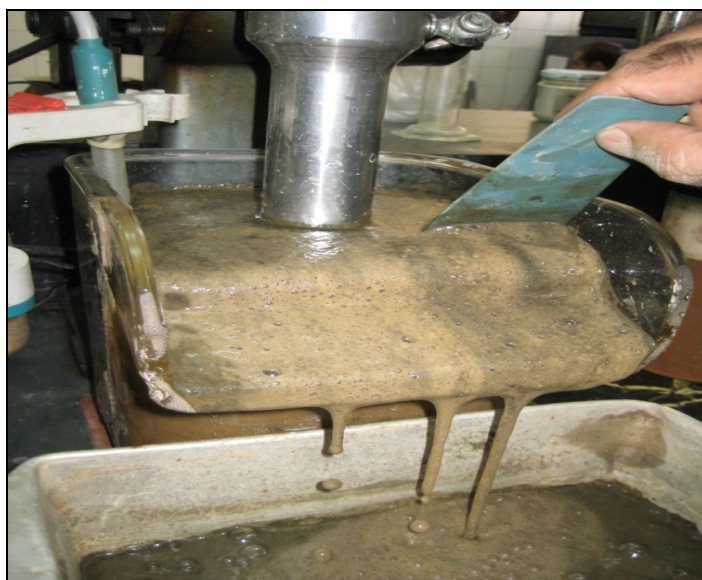
شکل ۳-۱۱: فلوتاسیون مرحله رافر نمونه یک کیلوگرمی
