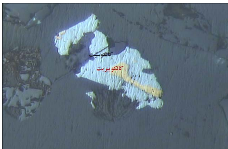
شکل ۳-۸: نماهایی از آلتراسیون شدید کالکوپیریت به کانی‌های ثانویه مس (کوولیت-دیجنیت، کالکوسیت) و اکسیدهای آهن در فراکسیون دانه‌بندی ۱۴۰-۲۰۰ مش. طول عکس‌ها ۱۷۵ میکرون
