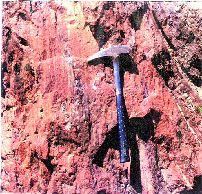
پراکنندگی سرب و روی در شکستگی های نوع شیر در سینه کار فوقانی کانسار (دید بسمت باختر).
