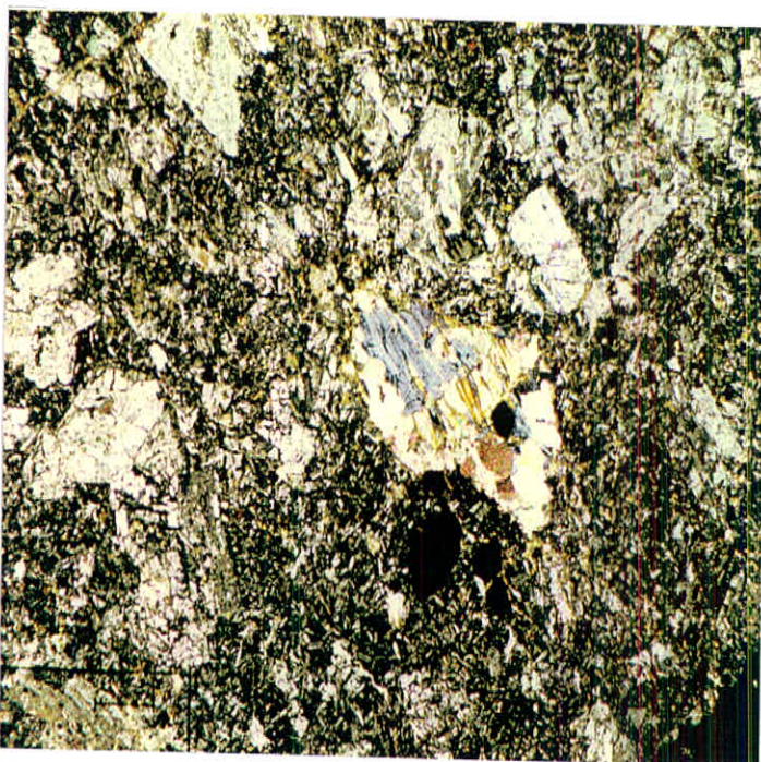
تجزیه به کلسیت و کلریت در میفیک در هیالو- بازالت پورفیریک (I.P.X25)
