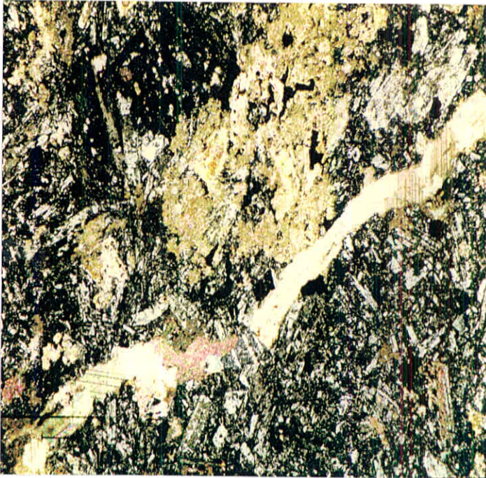
التراسیون کربناتیزاسیون در هیالوبا زالت پورفیریک (I.P.X25)
