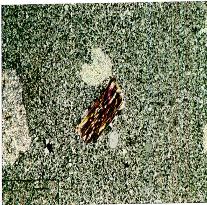
بلور اتومورف بیوتیت در داسیت پورفیریک (L.P. X25)
