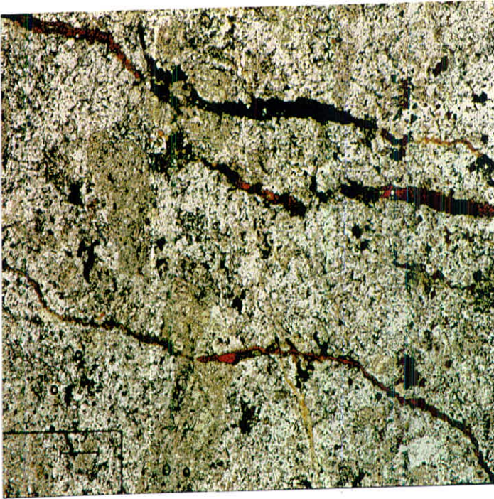
میکرو جوینت های پر شده از گوتیت و اپاک (L.P.X25)
