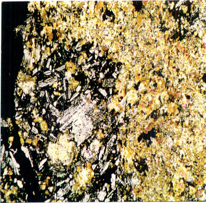
اپیدوتیزاسیون در هیالوبازالت پورفیری کوارتزایفر (L.P.X25)
