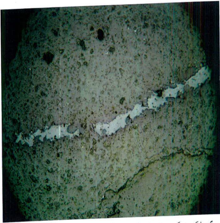
رگه-اکسید که بخشی از آن نیز لیمونیتی شده است مقطع ۵۳۸ بزرگنمایی ۶۰x
