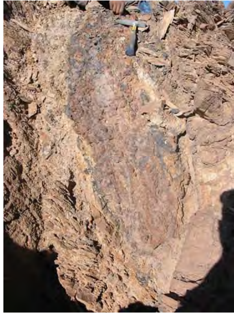
تصویر ۶-۸- بقایای رگه های معدنی در حد فاصل حفرات کارهای قدیمی
