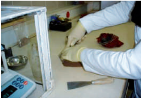
شکل ۲-۳. مرحله ورز دادن نمونه
