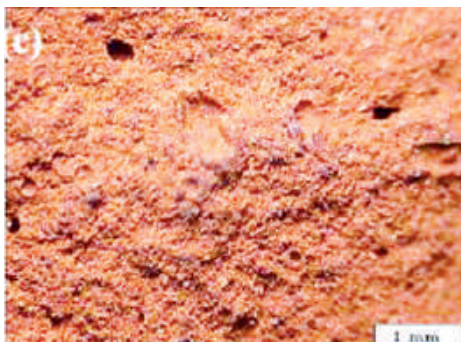
(a) خاک رس A، ۴۰ درصد فلوتاسیون آلپیت، ۱۱۰۰ °C (b) خاک رس A، ۴۰ درصد فلوتاسیون آلپیت، ۱۲۵۰ °C (c) خاک رس B، ۴۰ درصد فلوتاسیون آلپیت، ۱۲۰۰ °C
