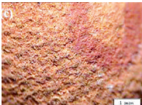
(a) خاک رس A، ۴۰ درصد فلوتاسیون آلپیت، ۱۱۰۰ °C (b) خاک رس A، ۴۰ درصد فلوتاسیون آلپیت، ۱۲۵۰ °C (c) خاک رس B، ۴۰ درصد فلوتاسیون آلپیت، ۱۲۰۰ °C
