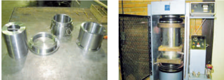
شکل ۱۱-۴. دستگاه تعیین مقاومت در برابر خردشدگی سبک‌دانه
