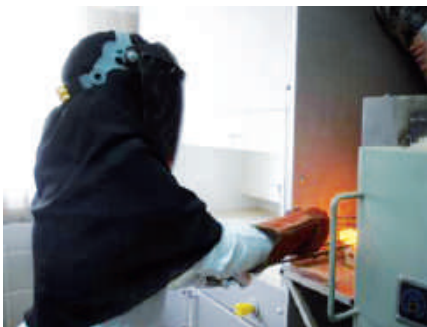
شکل ۴-۳. پخت گرانول‌های آزمایشگاهی در کوره
