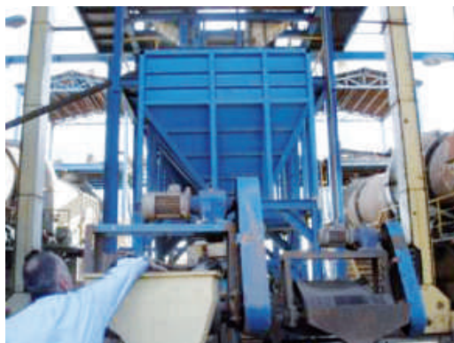
شکل ۳-۱۱. سرند گرانول‌ها بعد از مرحله خشک شدن
