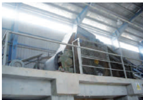
شکل ۳-۷. آسیاب غلتکی - افزودن آب به خاک
