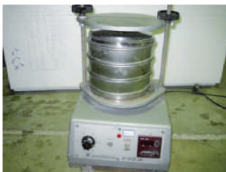
شکل ۴-۸ دستگاه شیکر و دانه‌بندی سبک‌دانه‌ها
