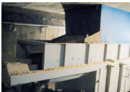
شکل ۳-۶. مخلوط‌کن - کلوخ‌شکنی و آسیاب اولیه شکل
