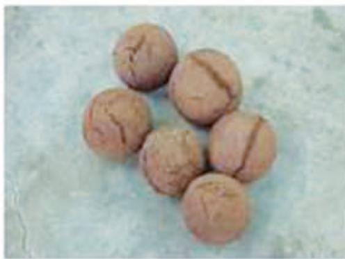
شکل ۱-۲۹. سنگدانه‌های تولید شده با افزودنی روغن ضایعاتی [۴]
