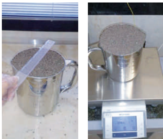
شکل ۴-۵. اندازه‌گیری چگالی انبوهی سبک‌دانه
