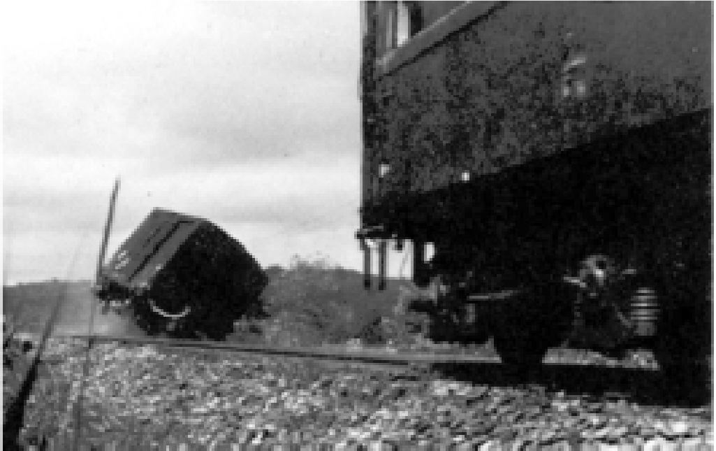
۸- آزمایشات برون-رفت قطار بر روی «خط آزمایش» و با استفاده از ریل‌ها و وسایل نقلیه‌ی مشابه ساخته، از سوی موسسه JNR
