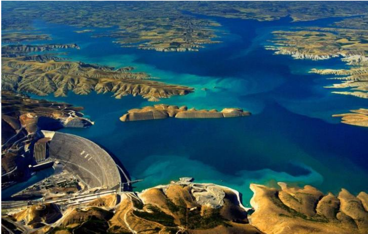
شکل ۶۵ سد آتاتورک در جنوب ترکیه و در سرشاخه‌های فرات با حجم مخزن ۴۸/۷ میلیارد متر مکعب (حجم مخزن کل سدهای ایران براساس آخرین اطلاعات دریافتی: ۴۸/۸ میلیارد متر مکعب)
