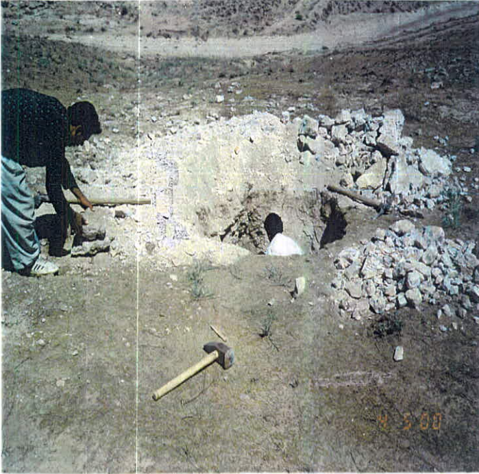
عکس شماره (۳-۱۳)- موقعیت چاهک Tp-7 نسبت به رودخانه خشک و سنگهای خارج شده از آن
