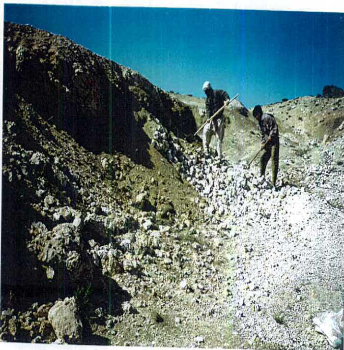
عکس شماره (۲-۷) روبرداری از نقاط مختلف منطقه جهت برداشت نمونه تست تکنولوژی در معدن
