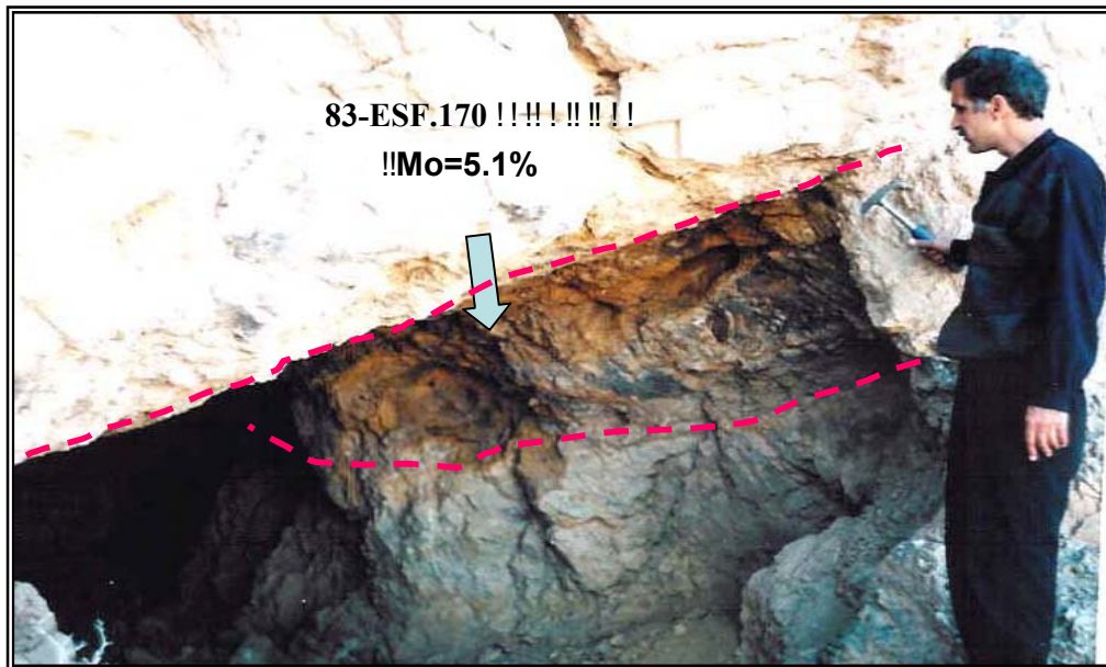
شکل ۴-۱۷: نمائی نزدیک از موقعیت کانی سازی در افق ۲ کانی سازی و محل نمونه برداری
