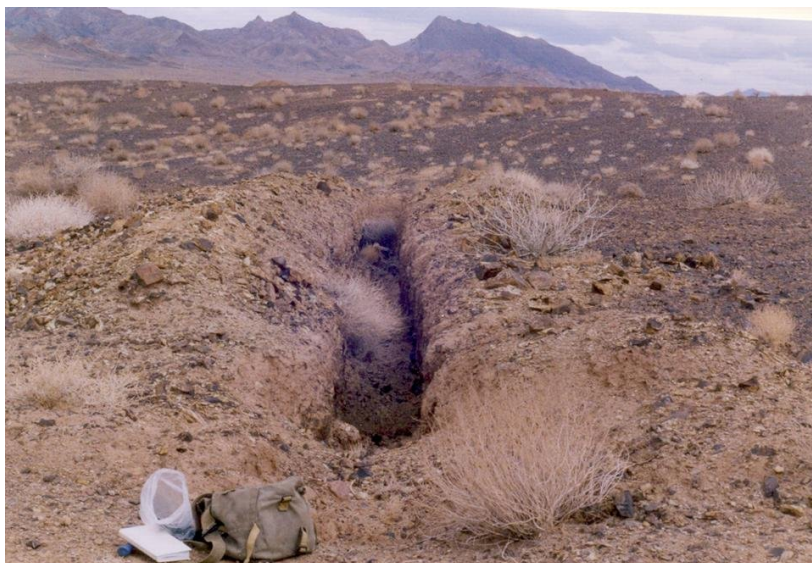
شکل ۴-۸: عملیات اکتشافی بصورت حفر ترانشه در معدن پرژام
