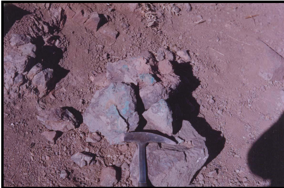
تصویر ۵-۶: آثار مالاکیت و آزوریت در سنگ میزبان دیابازی در محدوده کوه نرین
